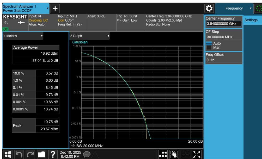
Plot 7-102. PAR Plot (NR Band n77 - 20MHz CP-OFDM 256-QAM - Full RB - Ant1 - C-Band)
