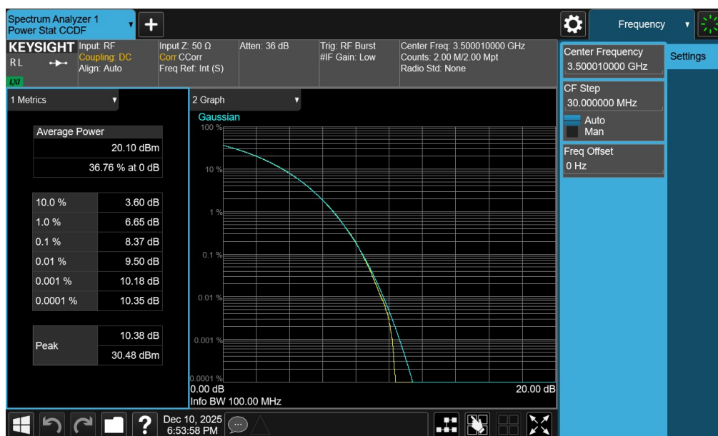
Plot 7-83. PAR Plot (NR Band n77 - 100MHz CP-OFDM 256-QAM - Full RB - Ant1 – DoD Band)
