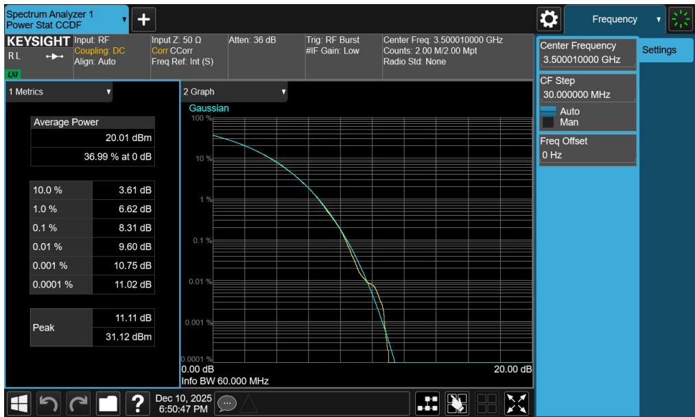
Plot 7-87. PAR Plot (NR Band n77 - 60MHz CP-OFDM 256-QAM - Full RB - Ant1 – DoD-Band)
