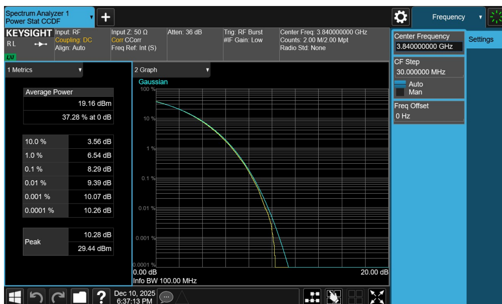
Plot 7-94. PAR Plot (NR Band n77 - 100MHz CP-OFDM 256-QAM - Full RB - Ant1 – C-Band)
