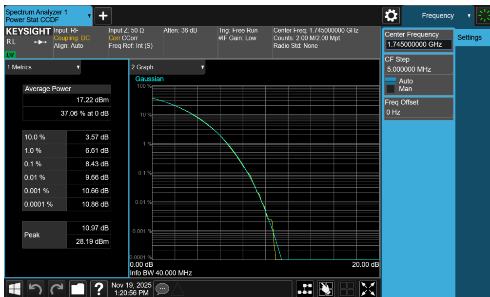
Plot 7-207. PAR Plot (NR Band n66 - 40.0MHz CP-OFDM 256-QAM - Full RB - ANT1)
