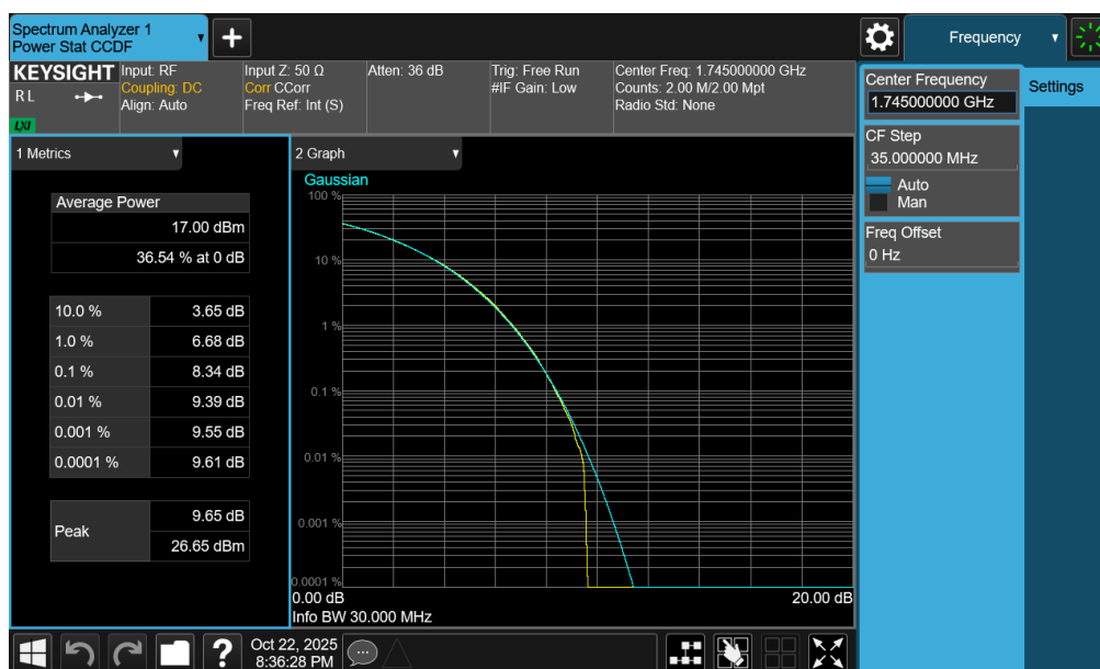
Plot 7-156. PAR Plot (NR Band n66 - 30.0MHz CP-OFDM 256-QAM - Full RB - ANT2)
