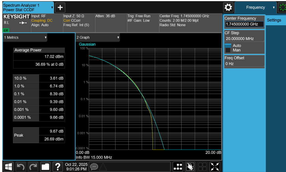
Plot 7-159. PAR Plot (NR Band n66 - 15.0MHz CP-OFDM 256-QAM - Full RB - ANT2)
