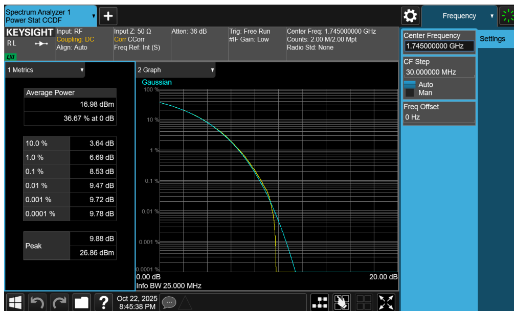
Plot 7-157. PAR Plot (NR Band n66 - 25.0MHz CP-OFDM 256-QAM - Full RB - ANT2)
