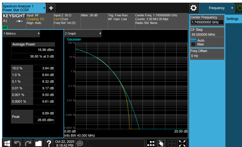
Plot 7-154. PAR Plot (NR Band n66 - 40.0MHz CP-OFDM 256-QAM - Full RB - ANT2)
