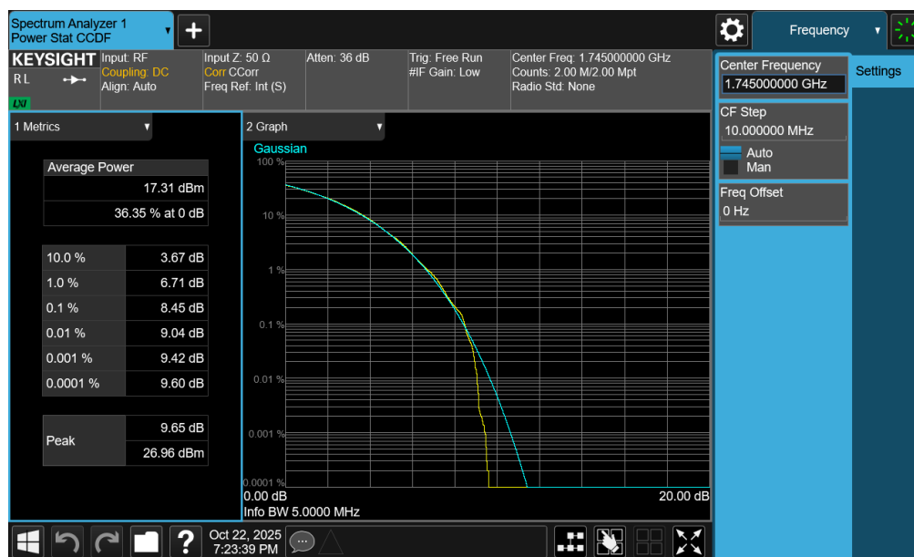
Plot 7-152. PAR Plot (NR Band n66 - 5.0MHz CP-OFDM 256-QAM - Full RB - ANT1)
