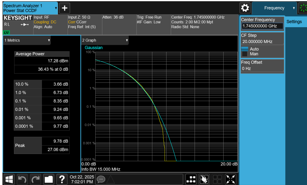
Plot 7-150. PAR Plot (NR Band n66 - 15.0MHz CP-OFDM 256-QAM - Full RB - ANT1)
