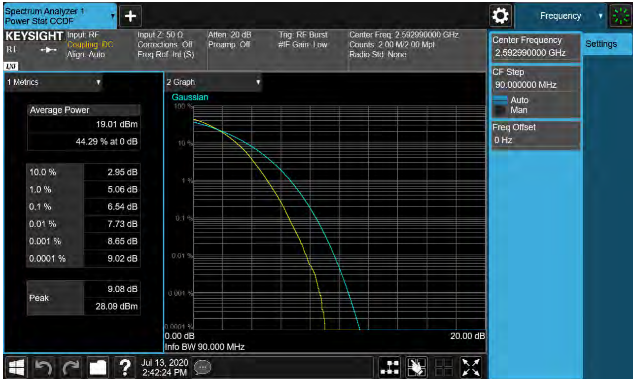
Sub6 n41. PAR Plot (90M BW_Ch.518598_256QAM_RB25_0)
