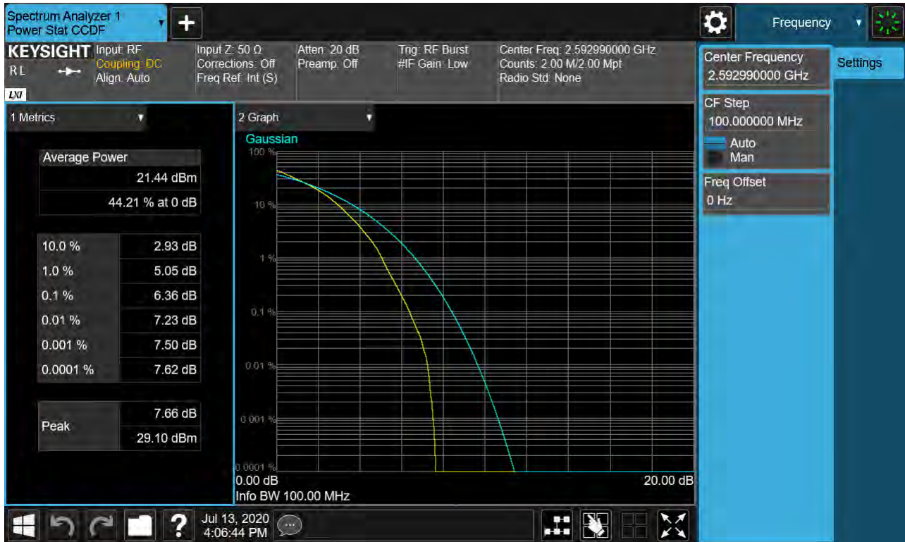
Sub6 n41. PAR Plot (100M BW_Ch.518598_16QAM_RB25_0)
