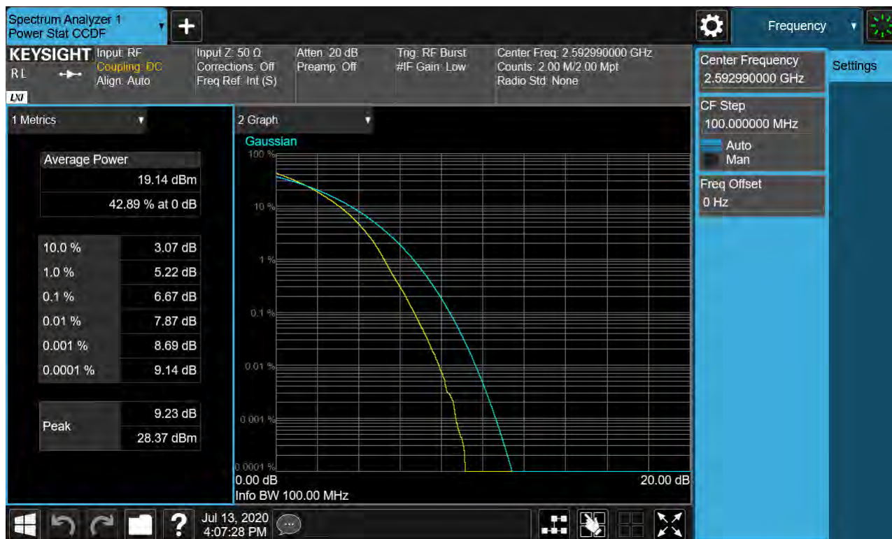
Sub6 n41. PAR Plot (100M BW_Ch.518598_256QAM_RB25_0)
