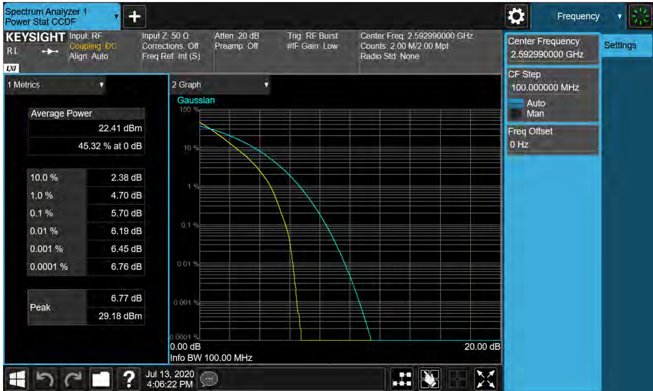
Sub6 n41. PAR Plot (100M BW_Ch.518598_QPSK_RB25_0)
