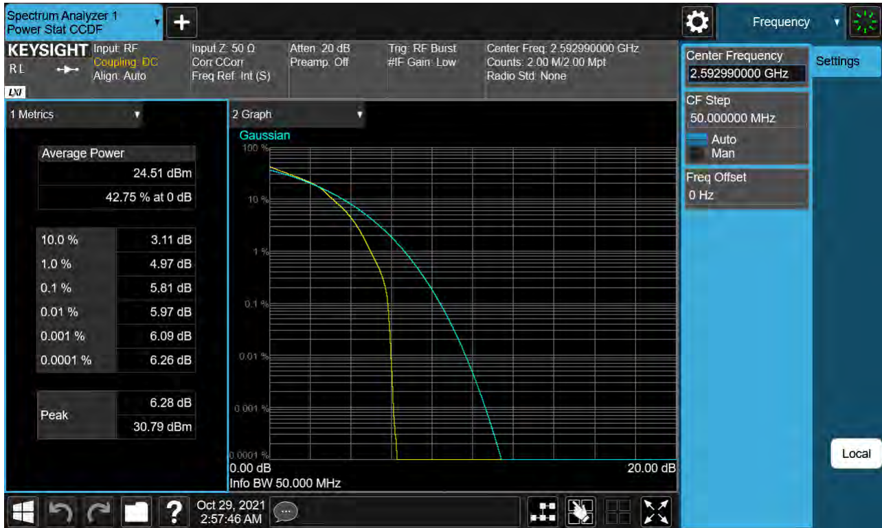
Sub6 n41. PAR Plot (50 M BW_Ch.518598_16QAM)
