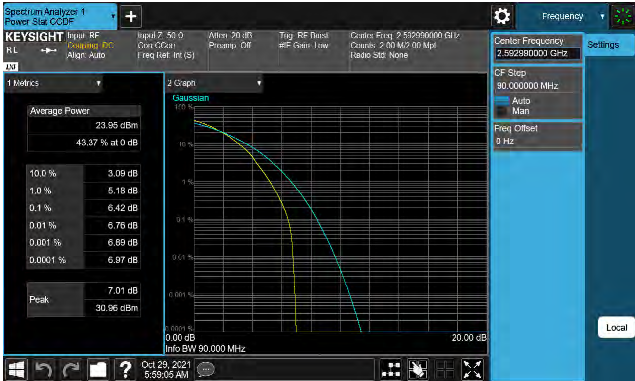
Sub6 n41. PAR Plot (90 M BW_Ch.518598_64QAM)
