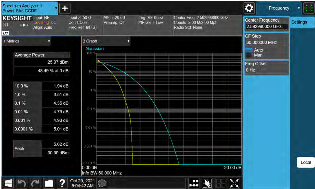
Sub6 n41. PAR Plot (60 M BW_Ch.518598_BPSK)
