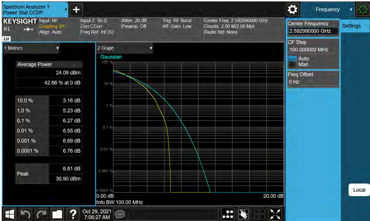
Sub6 n41. PAR Plot (100 M BW_Ch.518598_64QAM)
