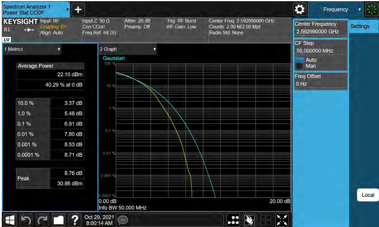
Sub6 n41. PAR Plot (50 M BW_Ch.518598_256QAM)
