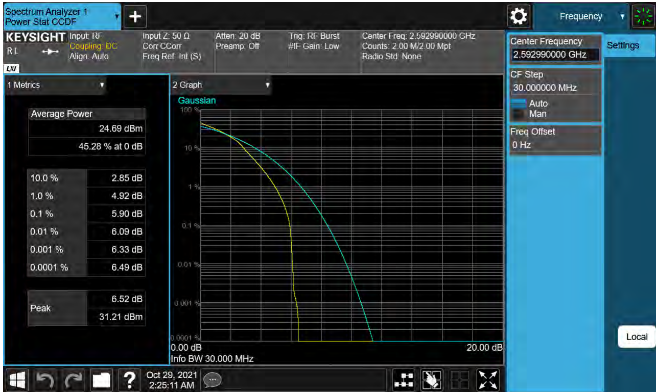
Sub6 n41. PAR Plot (30 M BW_Ch.518598_16QAM)
