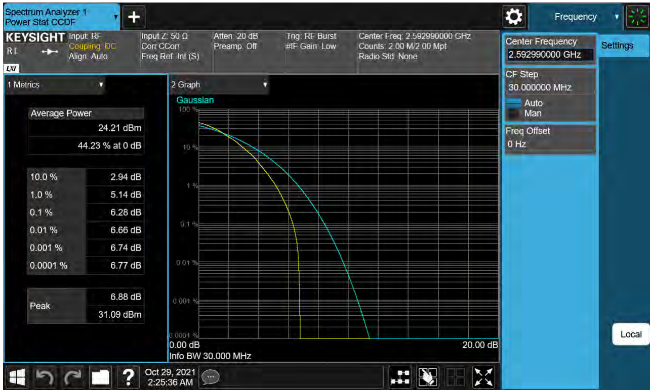
Sub6 n41. PAR Plot (30 M BW_Ch.518598_64QAM)
