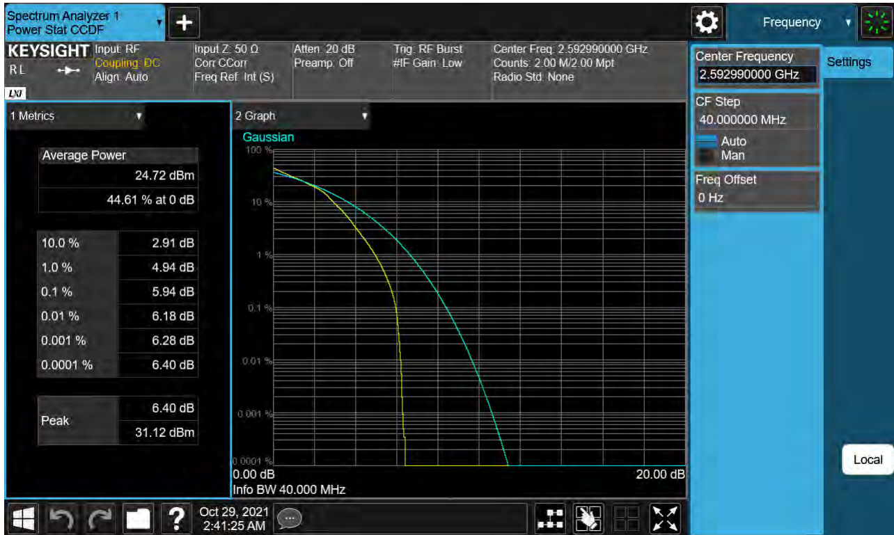
Sub6 n41. PAR Plot (40 M BW_Ch.518598_16QAM)
