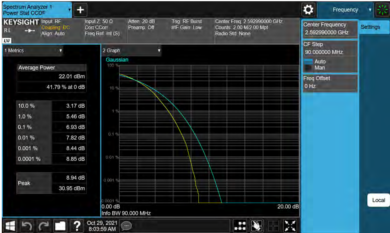
Sub6 n41. PAR Plot (90 M BW_Ch.518598_256QAM)
