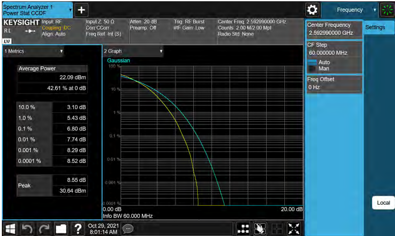
Sub6 n41. PAR Plot (60 M BW_Ch.518598_256QAM)
