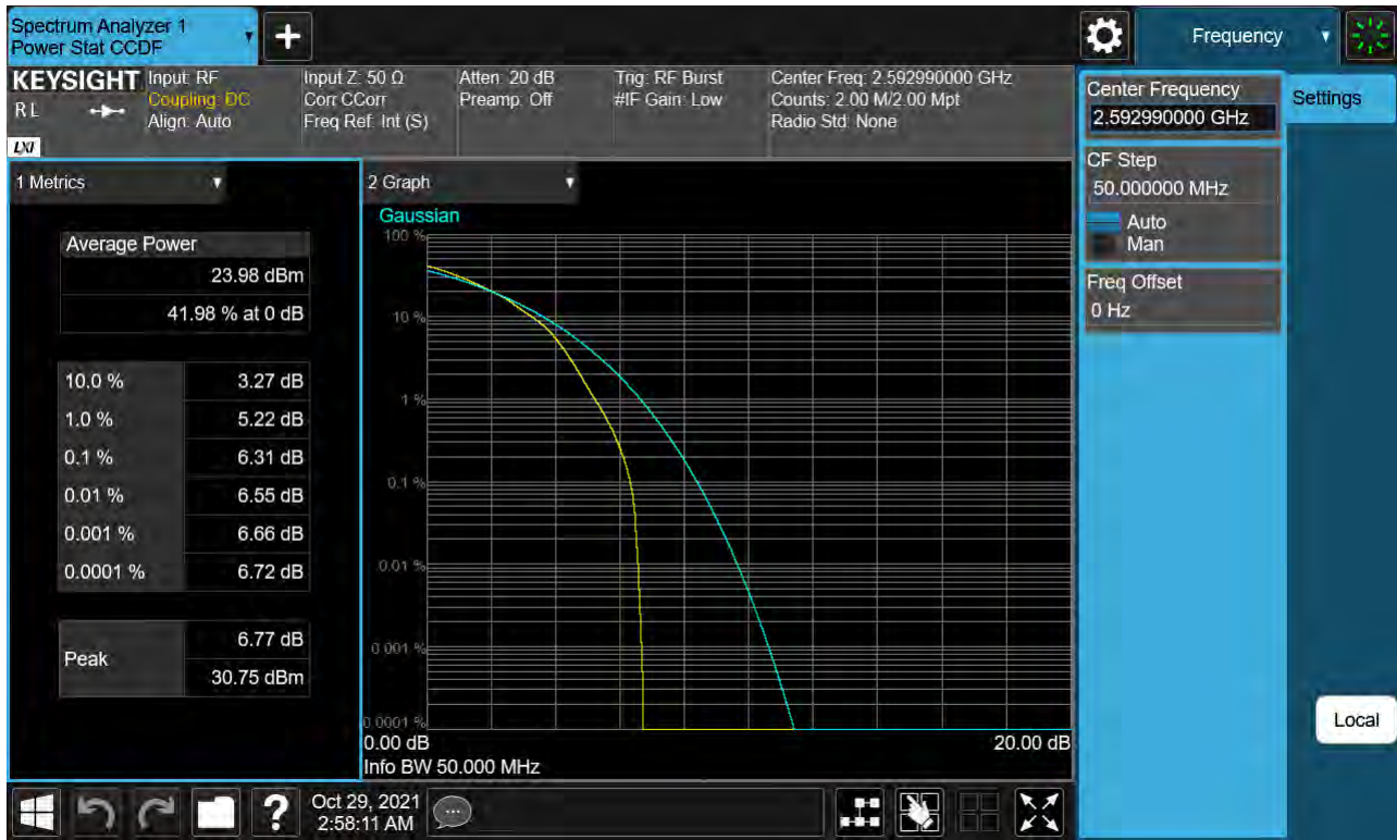
Sub6 n41. PAR Plot (50 M BW_Ch.518598_64QAM)
