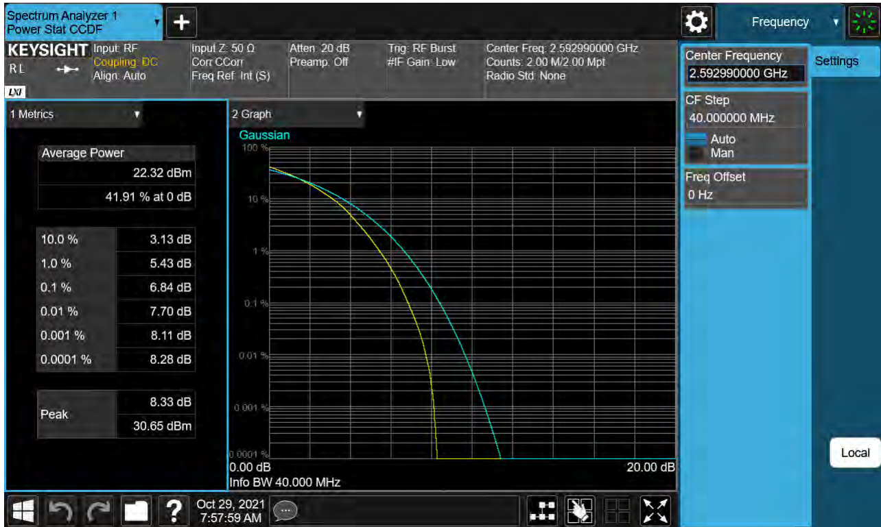
Sub6 n41. PAR Plot (40 M BW_Ch.518598_256QAM)
