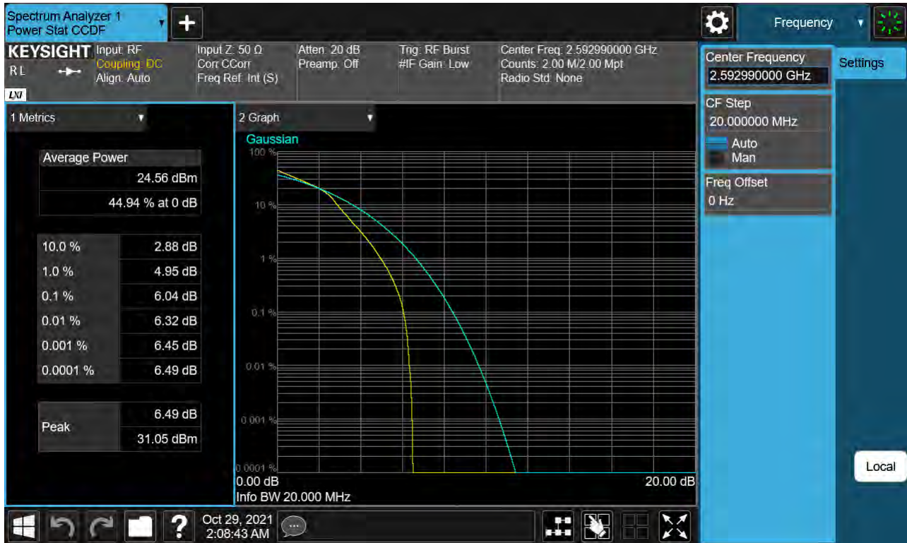
Sub6 n41. PAR Plot (20 M BW_Ch.518598_16QAM)
