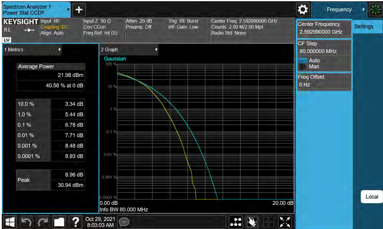
Sub6 n41. PAR Plot (80 M BW_Ch.518598_256QAM)
