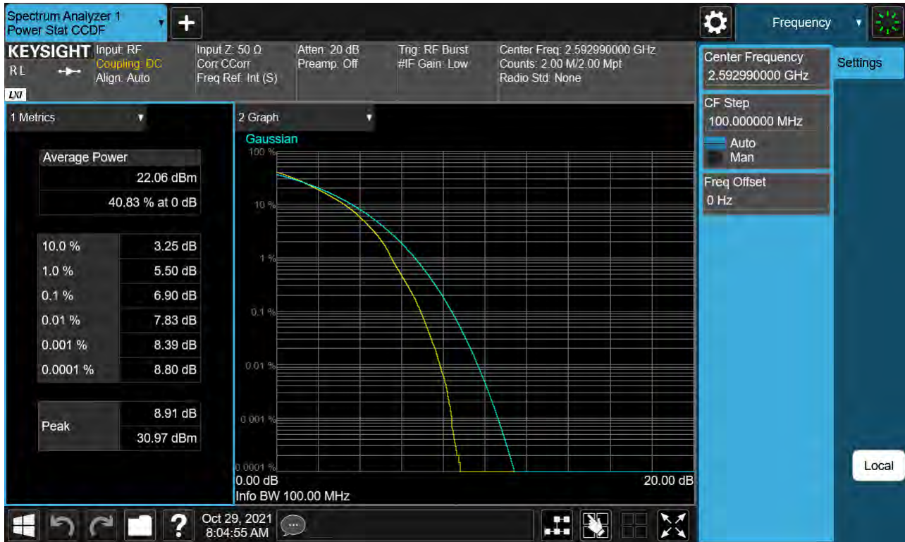
Sub6 n41. PAR Plot (100 M BW_Ch.518598_256QAM)
