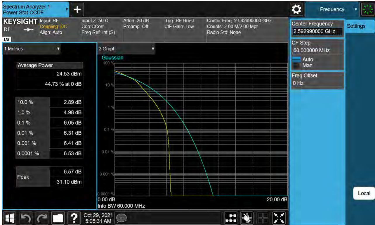
Sub6 n41. PAR Plot (60 M BW_Ch.518598_16QAM)
