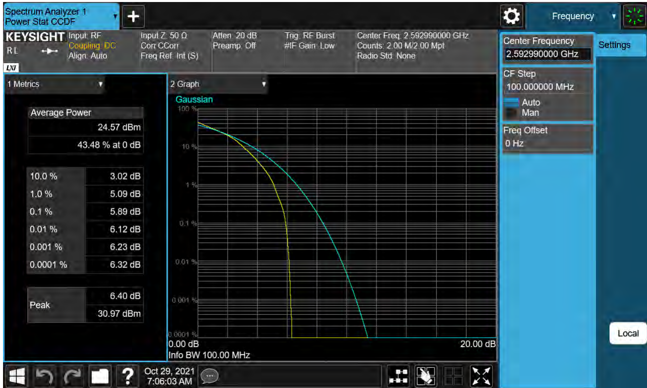
Sub6 n41. PAR Plot (100 M BW_Ch.518598_16QAM)
