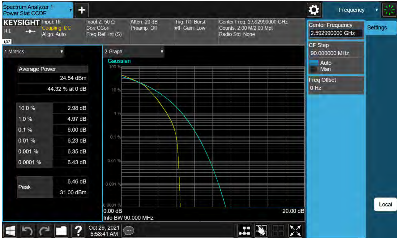
Sub6 n41. PAR Plot (90 M BW_Ch.518598_16QAM)
