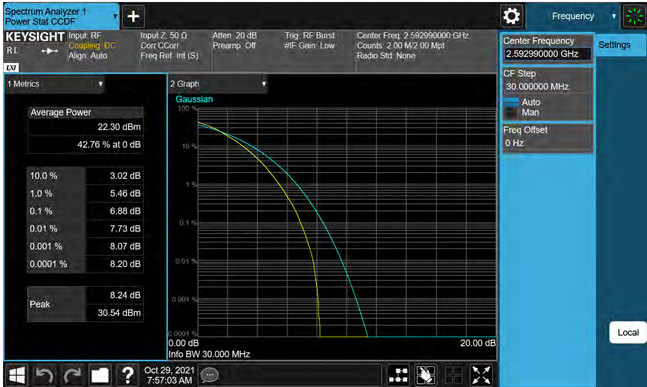
Sub6 n41. PAR Plot (30 M BW_Ch.518598_256QAM)
