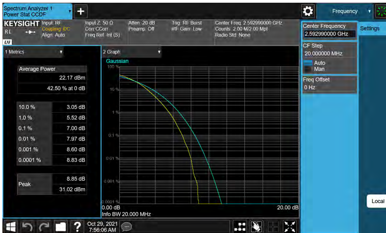
Sub6 n41. PAR Plot (20 M BW_Ch.518598_256QAM)
