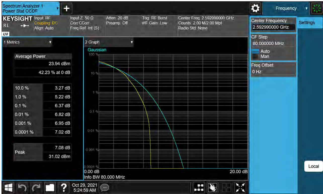
Sub6 n41. PAR Plot (80 M BW_Ch.518598_64QAM)
