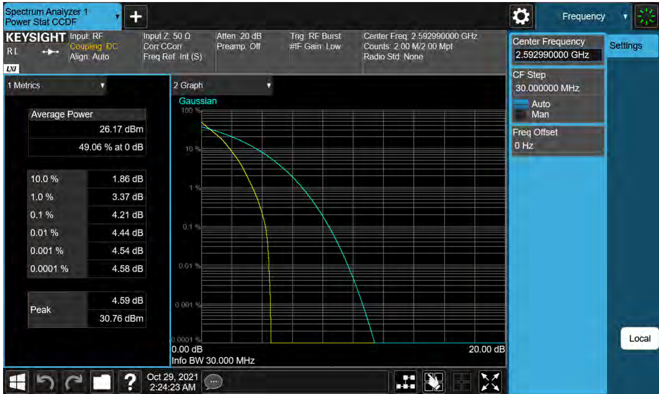
Sub6 n41. PAR Plot (30 M BW_Ch.518598_BPSK)
