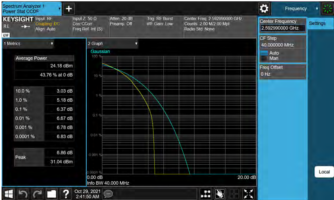
Sub6 n41. PAR Plot (40 M BW_Ch.518598_64QAM)
