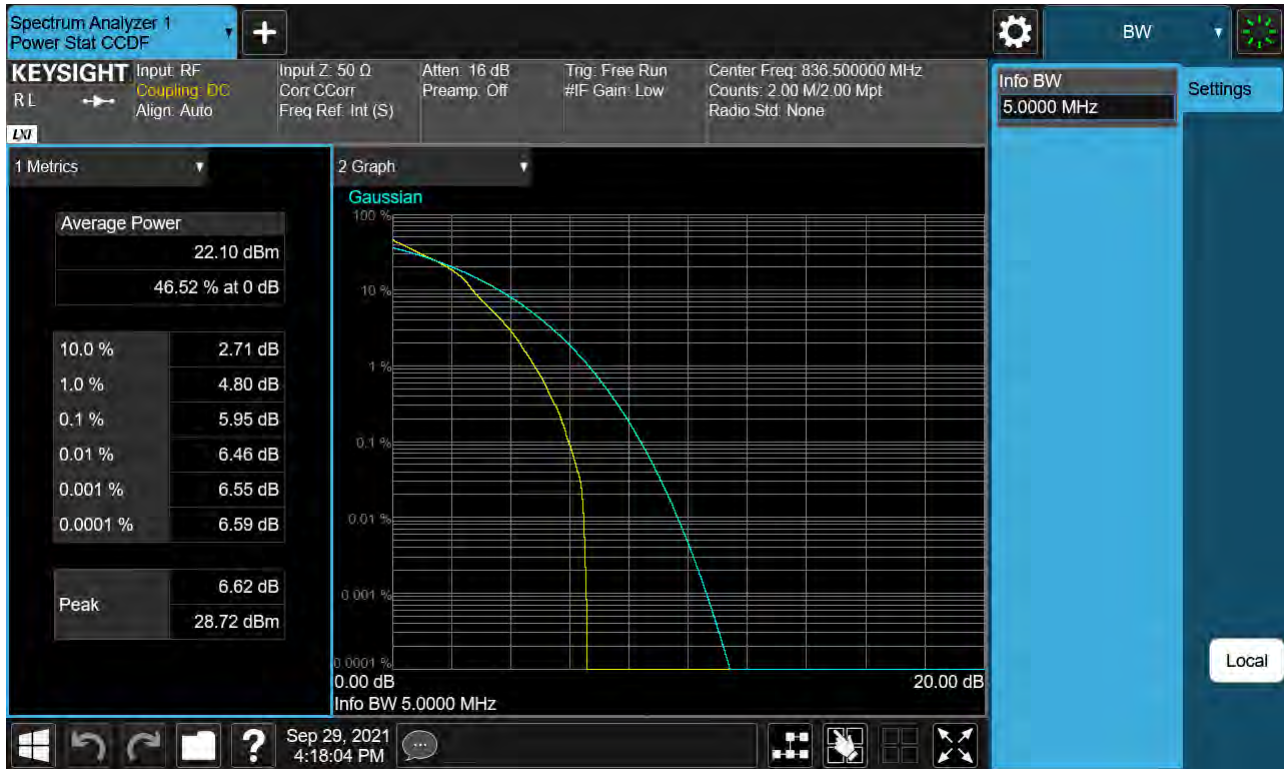
Sub6 n5. PAR Plot (5 M BW_Ch. 167300_16QAM_Full RB _0)
