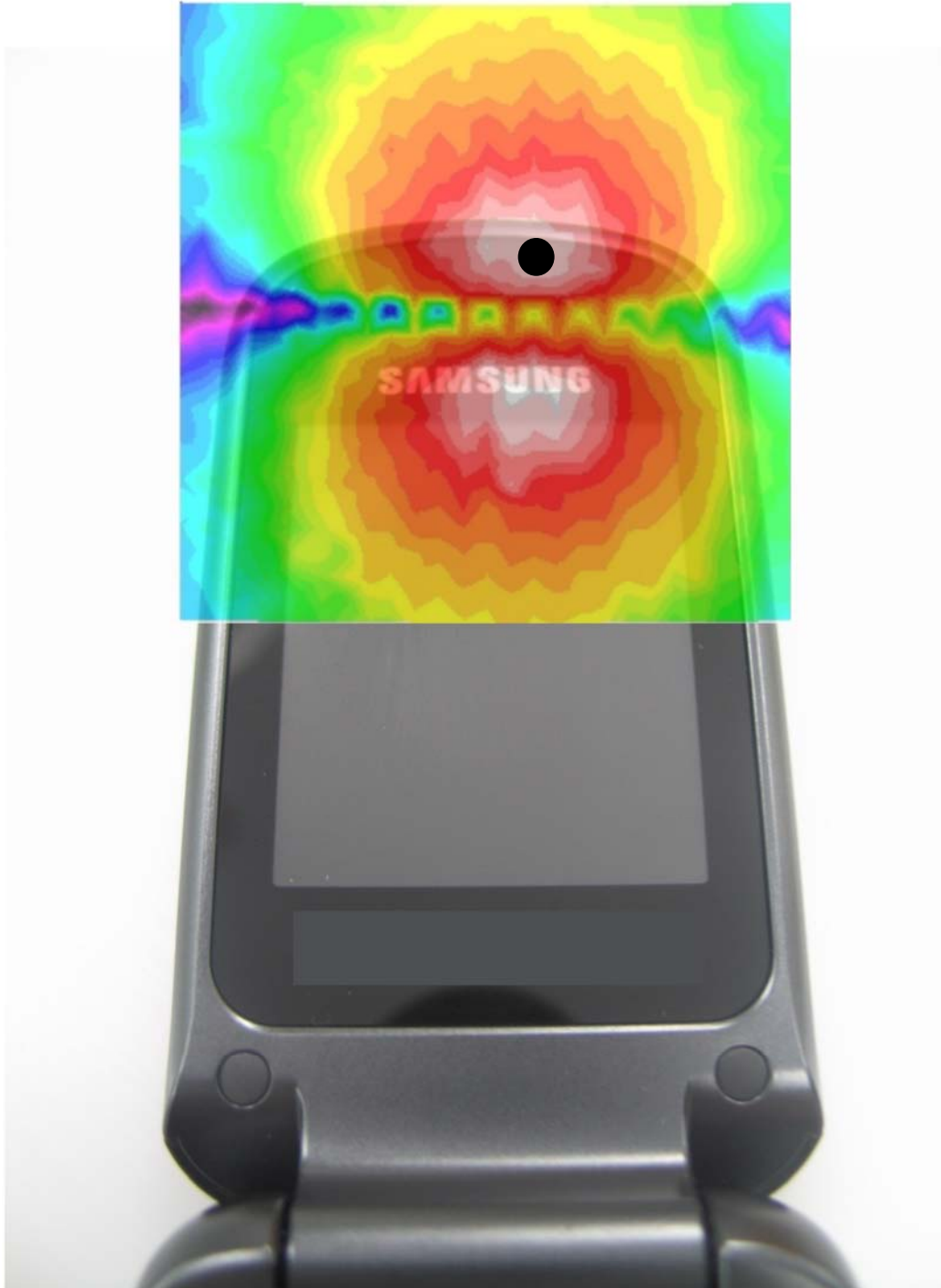
Scan overlay with actual device(Longitudinal)
