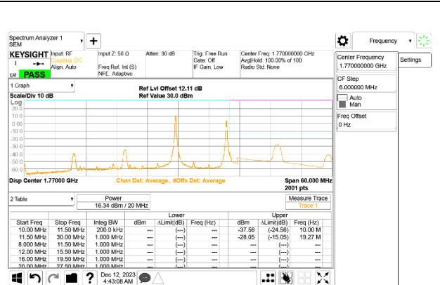
LTE B66B 10MHz + 10MHz QPSK High Ch RB1-49 + RB1-49 ID:32061
