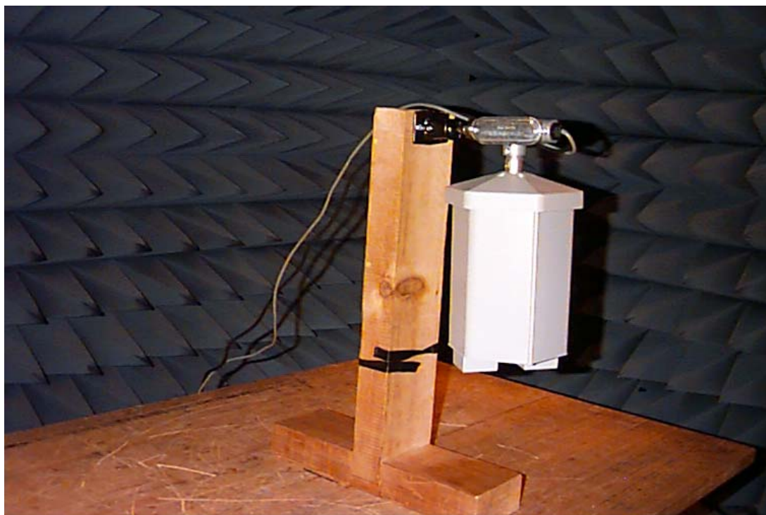
2.4GHz PIFA Antenna (integral), 0dBi
