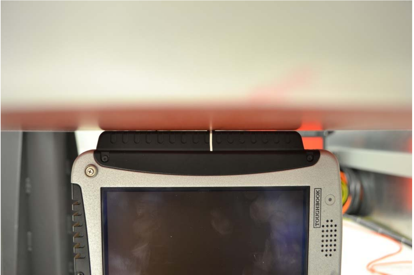
Edge 2, Main antenna
