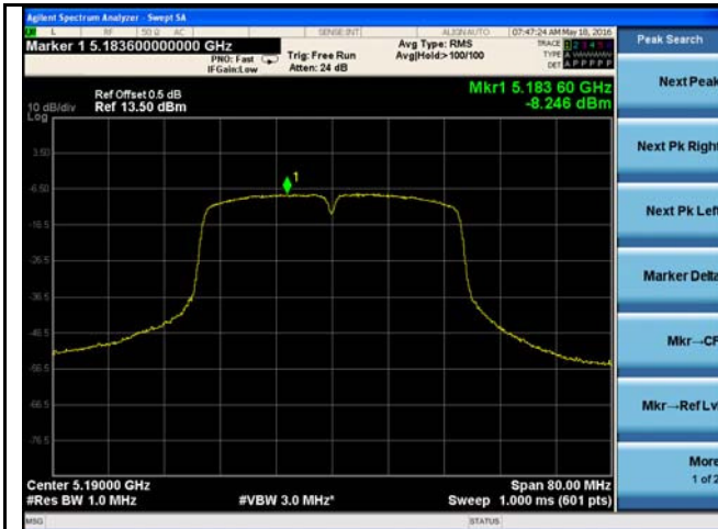
5150-5250MHz PSD - Low CH 5190
