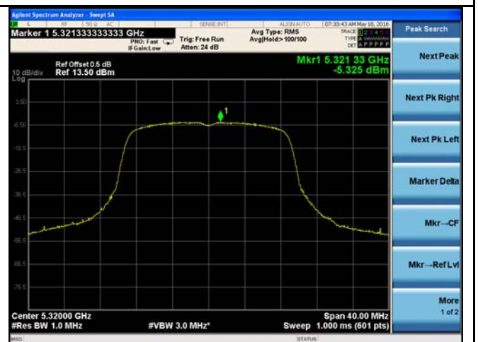
5250-5350MHz PSD - High CH 5320
