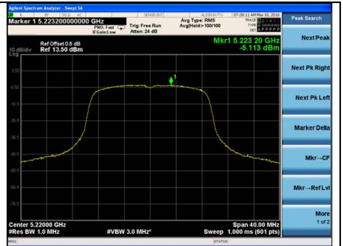
5150-5250MHz PSD - Middle CH 5220
