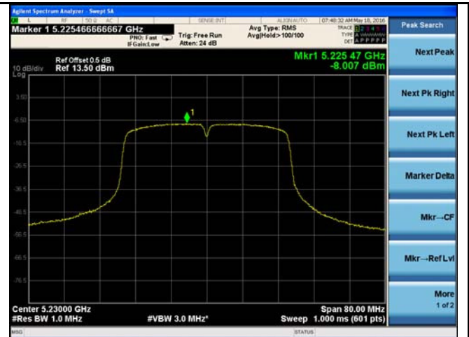
5150-5250MHz PSD - High CH 5230
