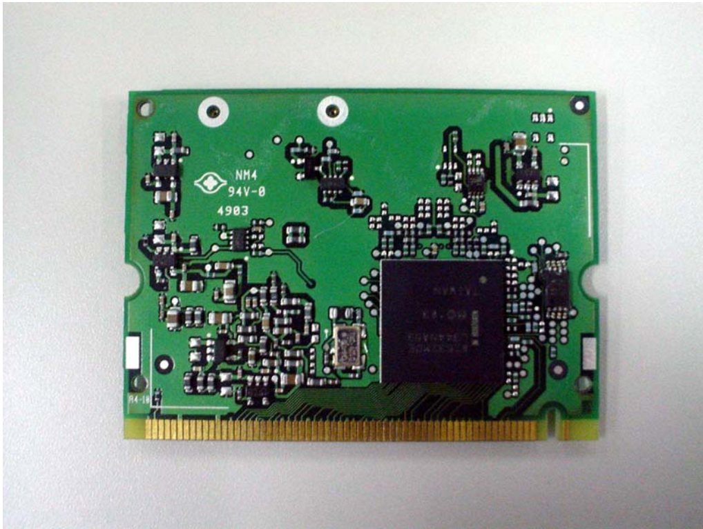
WLAN module: Side B
