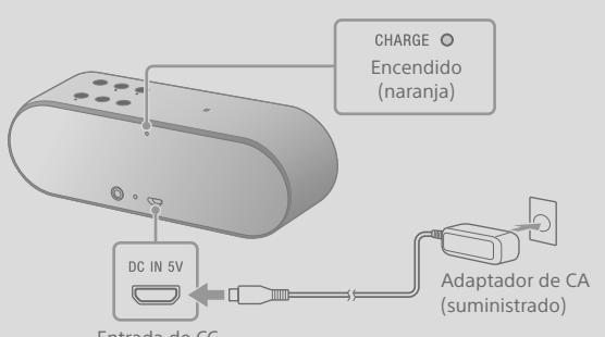
La carga comienza cuando la unidad se conecta a una toma de CA a través del adaptador de CA y el indicador de CHARGE muestra una luz naranja. La carga se completa en aproximadamente cuatro horas y el indicador se apaga.
