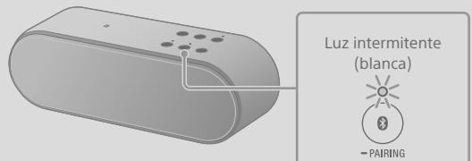
Cuando use la función BLUETOOTH por primera vez y cuando presione el botón (BLUETOOTH) – PAIRING, el indicador (BLUETOOTH) mostrará una luz intermitente rápida y la unidad ingresará automáticamente en el modo de conexión.
