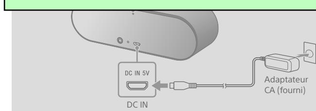
Le chargement démarre lorsque l'appareil est branché à une prise de courant via l'adaptateur CA, et le témoin CHARGE (orange) s'allume. Le chargement dure environ 4 heures, puis le témoin s'éteint.
