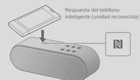
Siga las instrucciones sobre la pantalla para establecer la conexión. Cuando se establece la conexión de BLUETOOTH, el indicador (BLUETOOTH) en la unidad permanece encendido.
