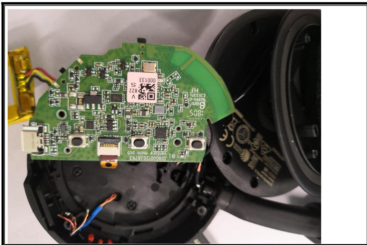
内部主板正面照片（去掉屏蔽罩放在旁边）
