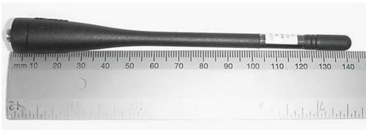
Whip Antenna (P/N: KRA-27(M2))
