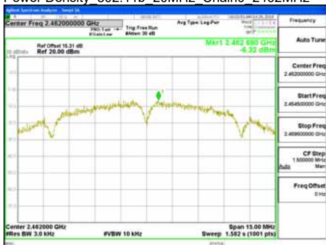
Power Density 802.11b 20MHz Chain0 2462MHz
