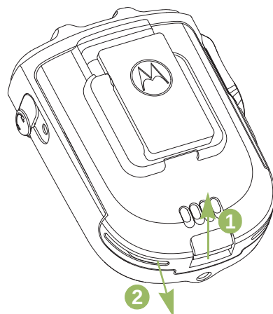
Figure 2.3: Retrait de la batterie du WRSM
