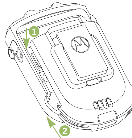
Figure 2.2: Fixation de la batterie au WSRM
