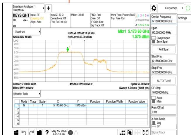
802.11be 20MHz Chain0 5180MHz RU106_53
