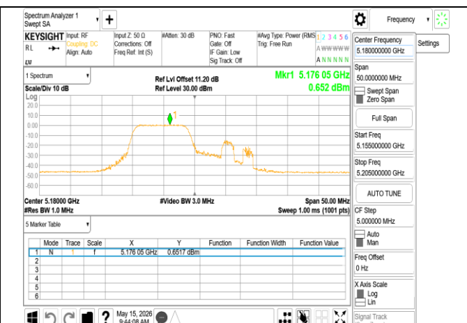
802.11be 20MHz Chain1 5180MHz RU106_53
