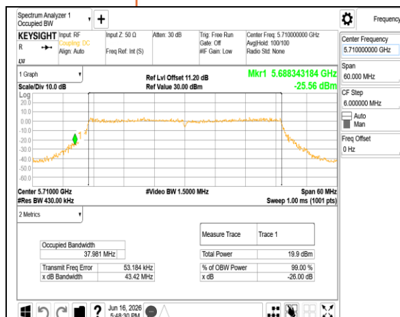
802.11be 40MHz Chain1 5710MHz UNII-2CRU484
