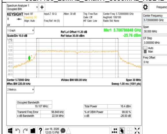
802.11be 20MHz Chain1 5720MHz UNII-2CRU242
