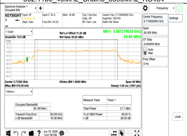
802.11be 40MHz Chain0 5710MHz UNII-2CRU484
