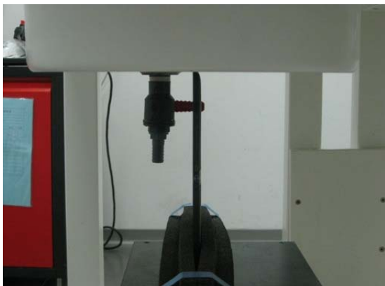
Fig.5 EUT Right Edge to flat phantom
