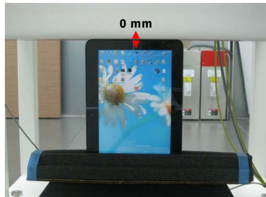
Fig.5 EUT Right Edge to flat phantom
