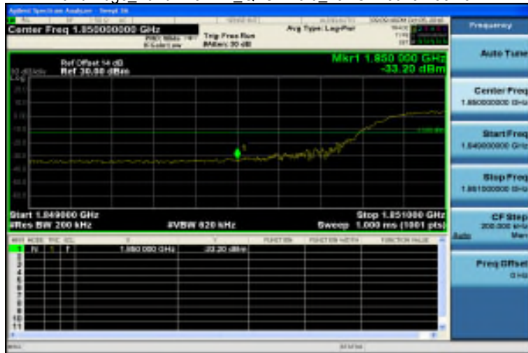
Band Edge_Band2 15MHz_QPSK 75 0_LowCH18675-1857.5
