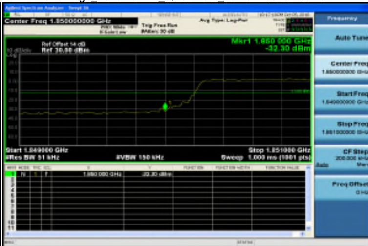
Band Edge_Band2 5MHz_QPSK 25 0_LowCH18625-1852.5
