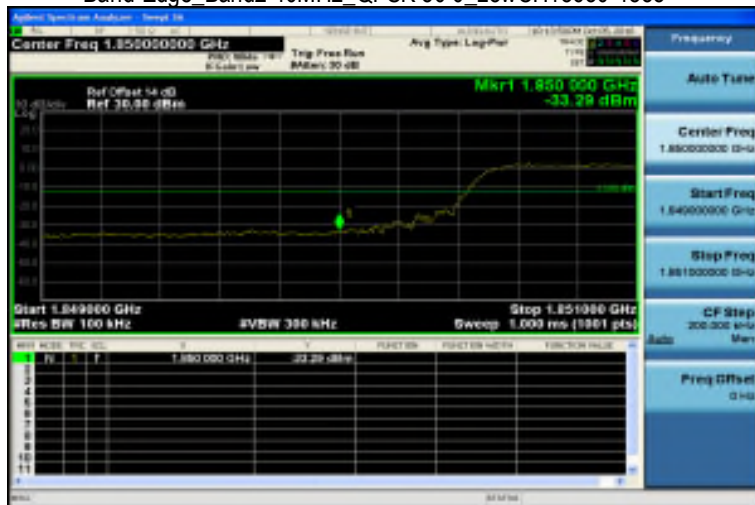
Band Edge_Band2 10MHz_QPSK 50 0_LowCH18650-1855
