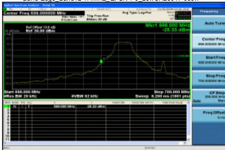
Band Edge_Band12 1.4MHz_QPSK 1 0_LowCH23017-699.7
