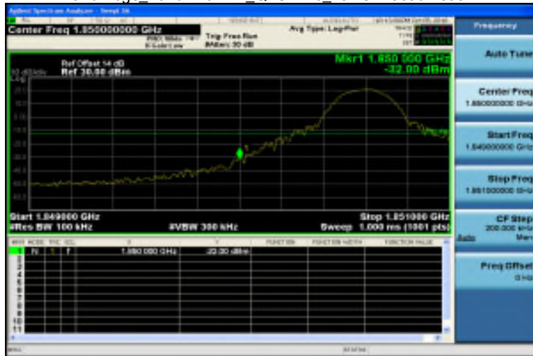
Band Edge_Band2 10MHz_QPSK 1 0_LowCH18650-1855
