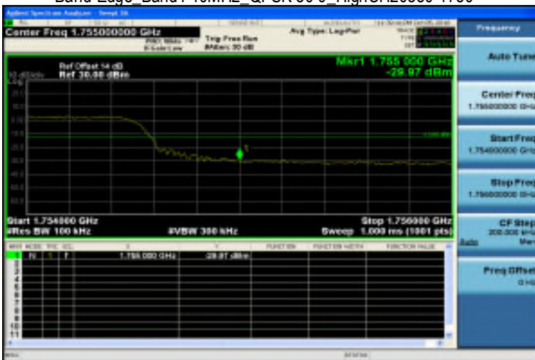
Band Edge_Band4 10MHz_QPSK 50 0_HighCH20350-1750
