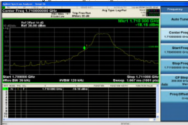
Band Edge_Band4 3MHz_QPSK 1 0_LowCH19965-1711.5
