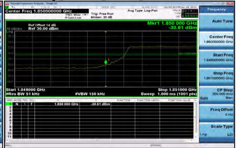
Band Edge_Band2 5MHz_QPSK 25 0_LowCH18625-1852.5
