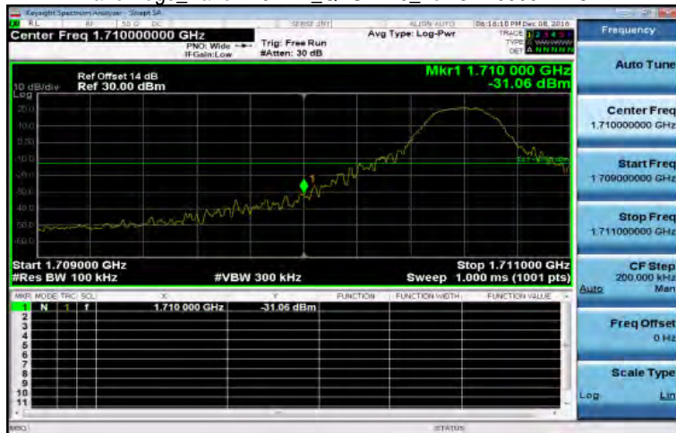
Band Edge_Band4 10MHz_QPSK 1 0_LowCH20000-1715
