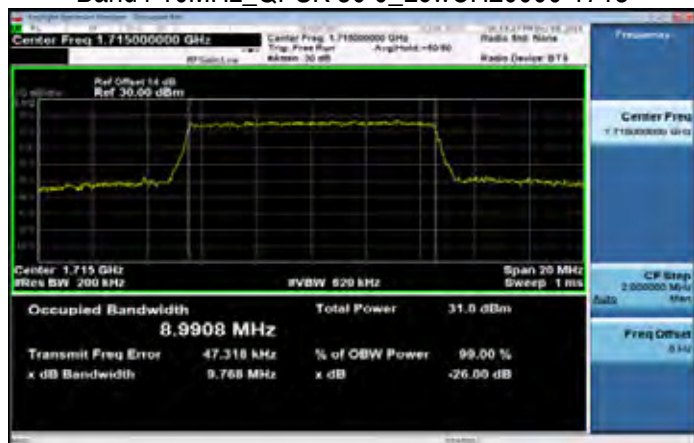
Band4 10MHz_QPSK 50 0_LowCH20000-1715
