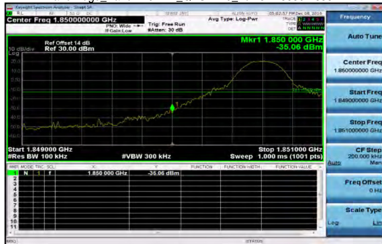
Band Edge_Band2 10MHz_QPSK 1 0_LowCH18650-1855
