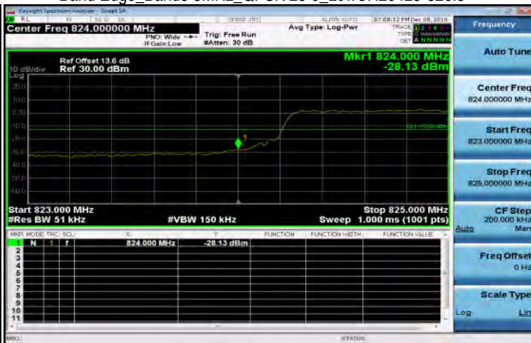
Band Edge_Band5 5MHz_QPSK 25 0_LowCH20425-826.5
