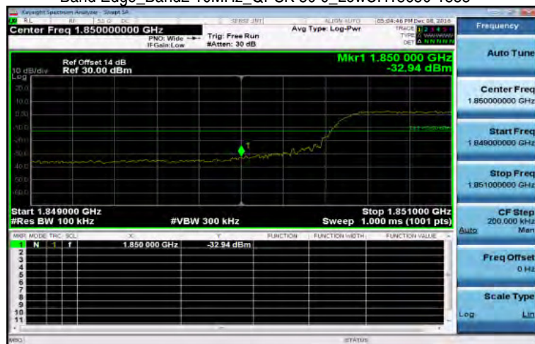
Band Edge_Band2 10MHz_QPSK 50 0_LowCH18650-1855
