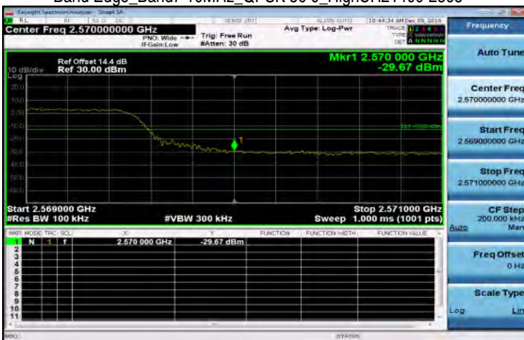
Band Edge_Band7 10MHz_QPSK 50 0_HighCH21400-2565
