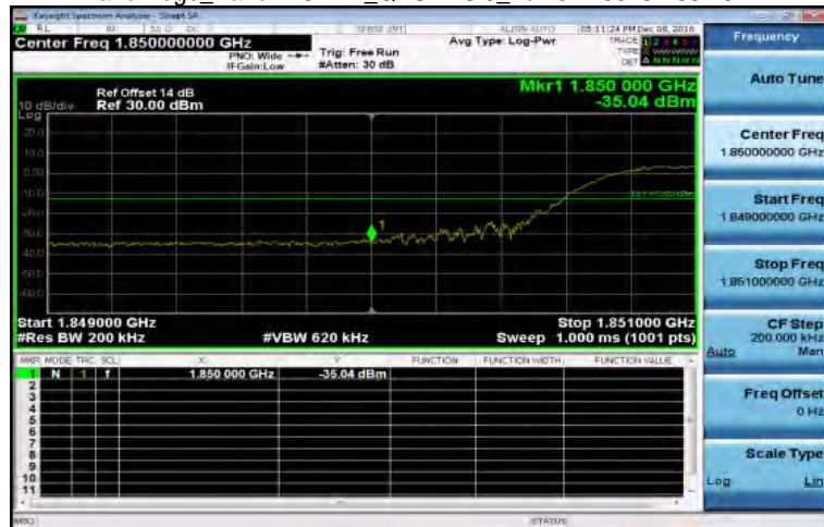
Band Edge_Band2 15MHz_QPSK 75 0_LowCH18675-1857.5
