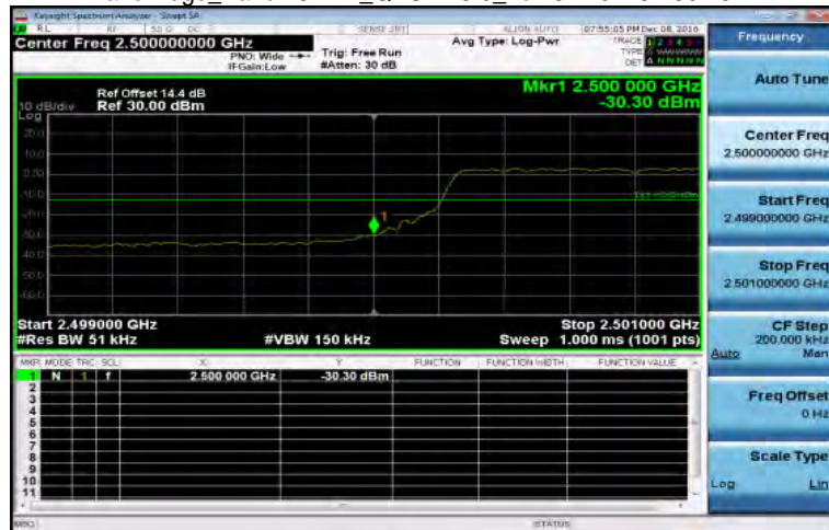
Band Edge_Band7 5MHz_QPSK 25 0_LowCH20775-2502.5
