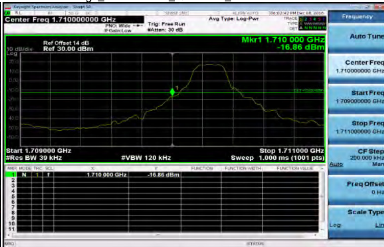
Band Edge_Band4 3MHz_QPSK 1 0_LowCH19965-1711.5
