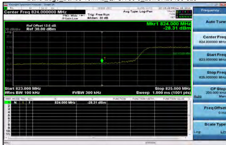
Band Edge_Band5 10MHz_QPSK 50 0_LowCH20450-829
