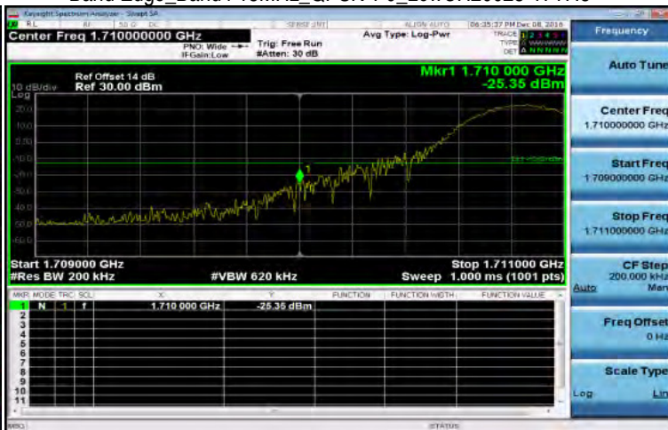
Band Edge_Band4 15MHz_QPSK 1 0_LowCH20025-1717.5
