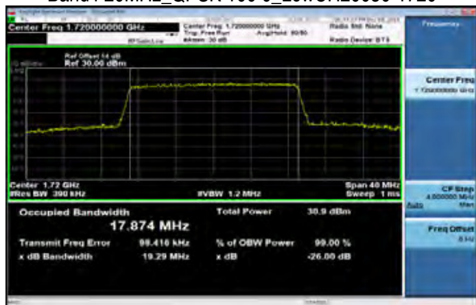
Band4 20MHz_QPSK 100 0_LowCH20050-1720
