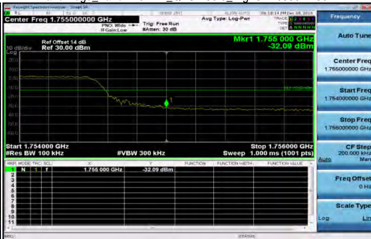
Band Edge_Band4 10MHz_QPSK 50 0_HighCH20350-1750
