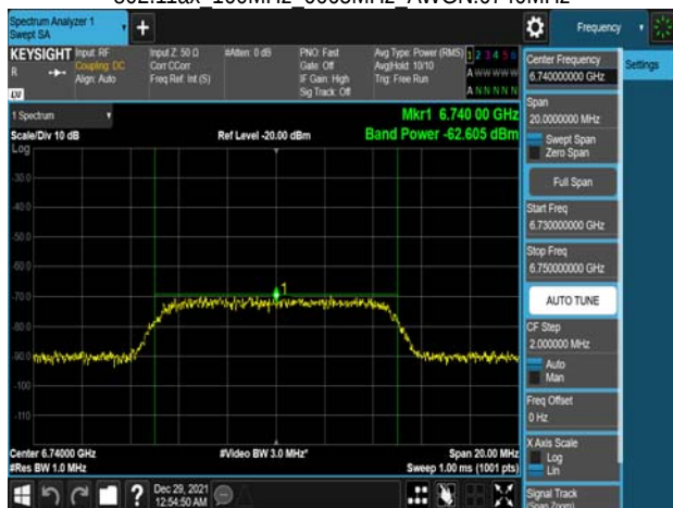
802.11ax 160MHz 6985MHz AWGN:6910MHz
