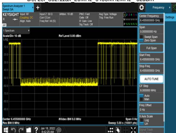
Det LeI 802.11ax 20MHz 6455MHzMHz -62dBm
