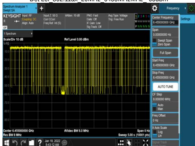
Det Le1 802.11ax 20MHz 6455MHzMHz -65dBm
