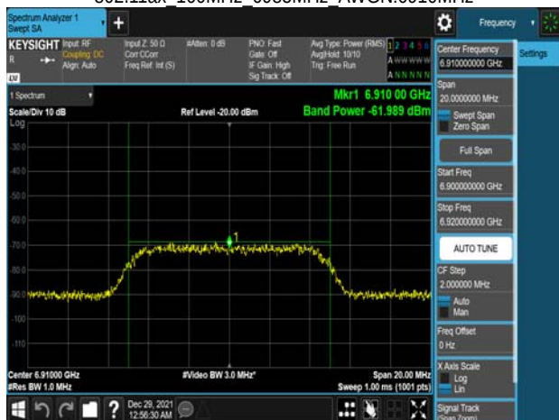
802.11ax 160MHz 6985MHz AWGN:6985MHz
