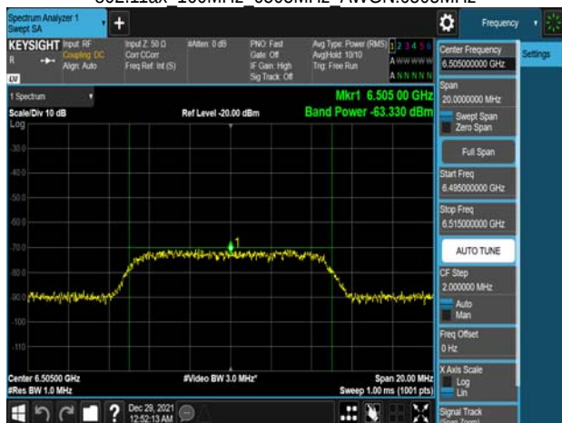
802.11ax 160MHz 6505MHz AWGN:6505MHz
