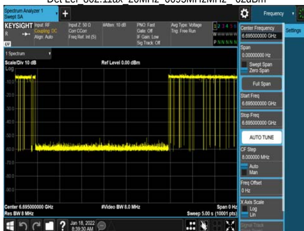
Det Le1 802.11ax 20MHz 6695MHzMHz -63dBm
