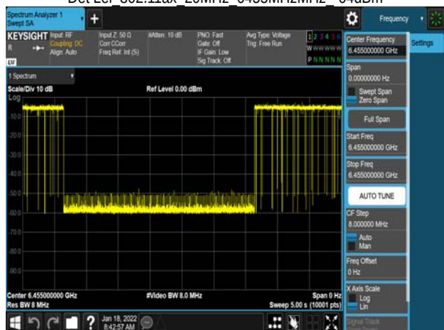
Det Le1 802.11ax 20MHz 6455MHzMHz -65dBm
