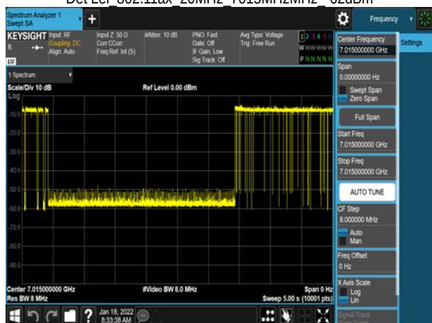
Det Le1 802.11ax 20MHz 7015MHzMHz -63dBm
