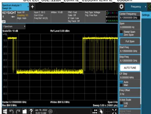
Det LeI 802.11ax 20MHz 6135MHzMHz -66dBm
