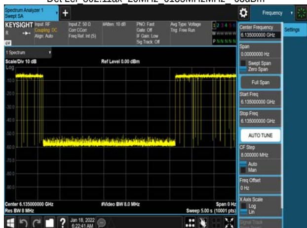
Det LeI 802.11ax 20MHz 6135MHzMHz -64dBm
