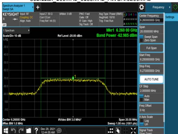
802.11ax 160MHz 6505MHz AWGN:6430MHz
