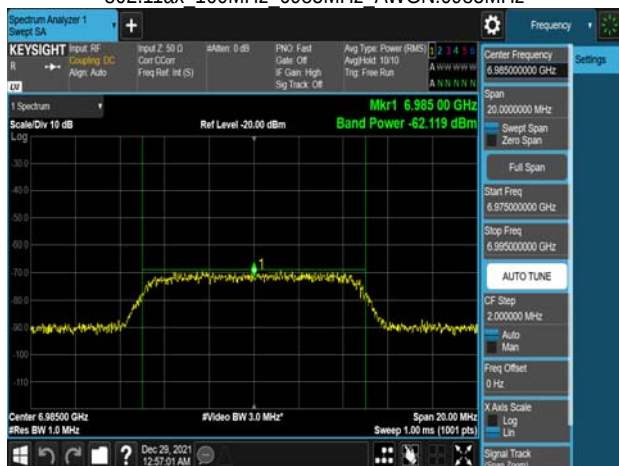
802.11ax 160MHz 6985MHz AWGN:6985MHz
