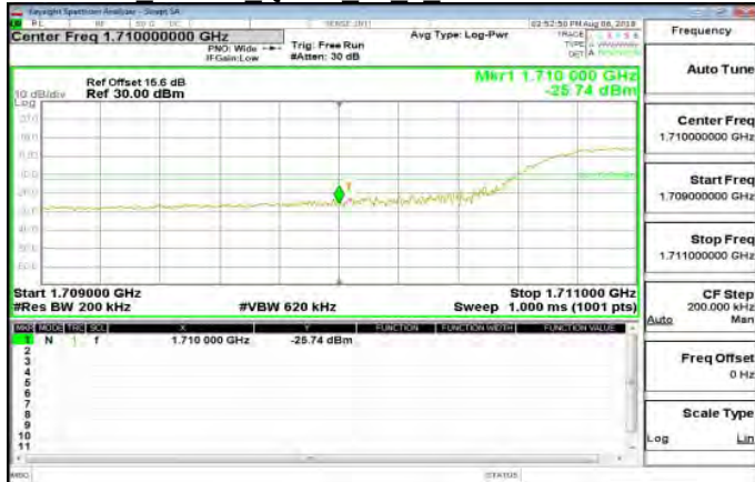
Band4 15MHz QPSK 75 0 LowCH20025-1717.5
