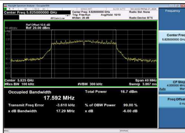
U-NII-3 6dB Bandwidth-802.11ac(20MHz) ,5825MHz,Ant1
