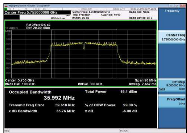
U-NII-3 6dB Bandwidth-802.11ac(40MHz) ,5755MHz,Ant1
