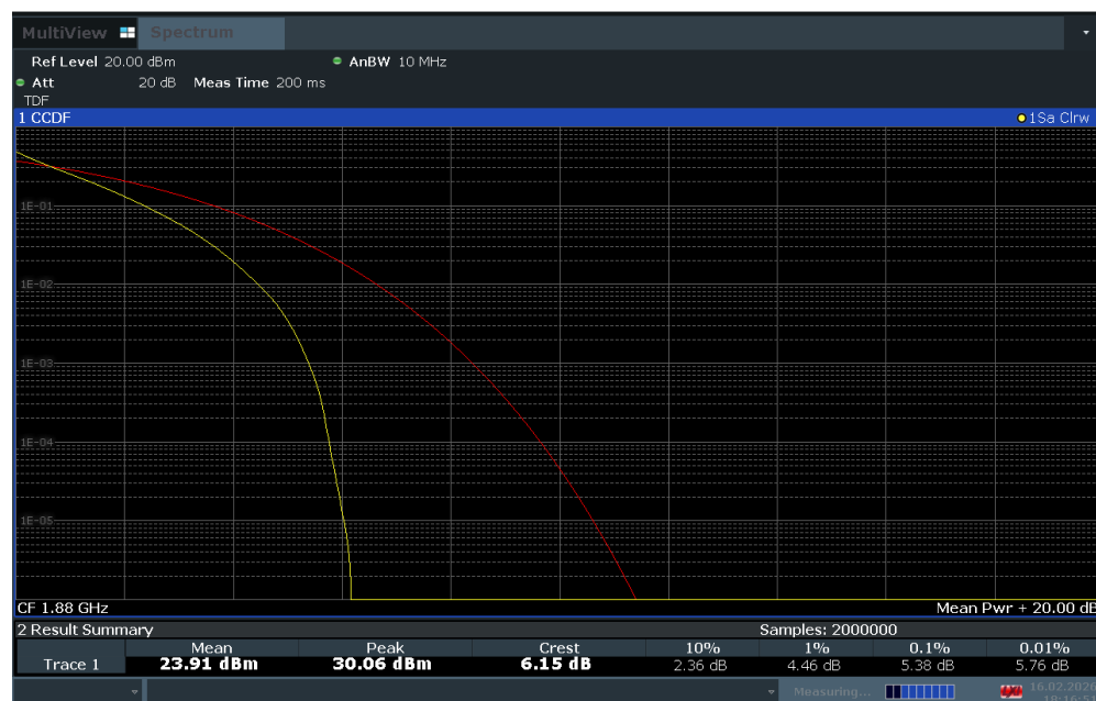
Plot 7-141. PAR Plot (LTE Band 2 - 10MHz QPSK - Full RB Configuration)
