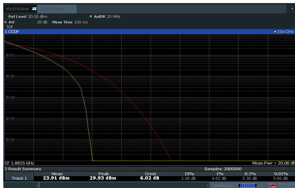
Plot 7-131. PAR Plot (LTE Band 25 - 15MHz QPSK - Full RB Configuration)
