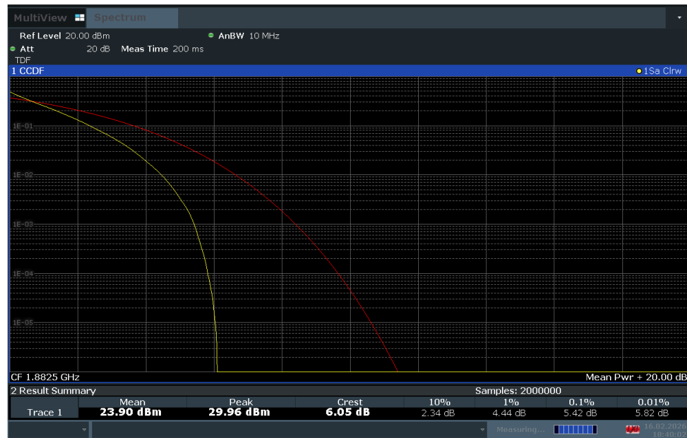
Plot 7-129. PAR Plot (LTE Band 25 - 10MHz QPSK - Full RB Configuration)
