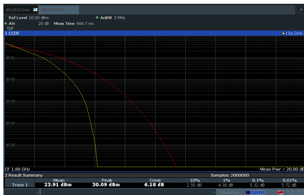
Plot 7-137. PAR Plot (LTE Band 2 - 3MHz QPSK - Full RB Configuration)
