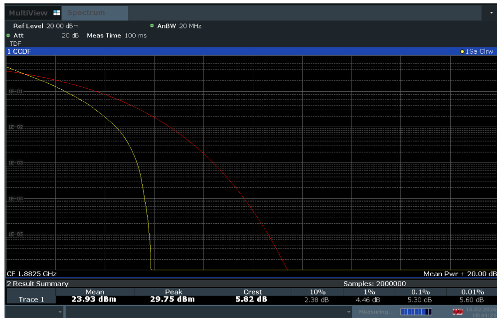
Plot 7-133. PAR Plot (LTE Band 25 - 20MHz QPSK - Full RB Configuration)
