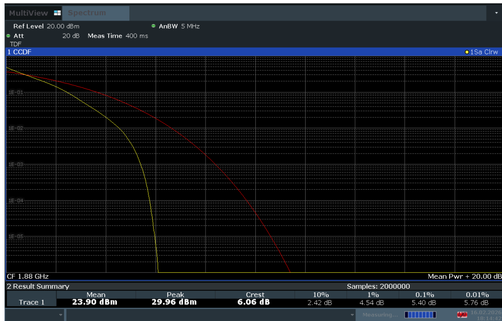
Plot 7-139. PAR Plot (LTE Band 2 - 5MHz QPSK - Full RB Configuration)
