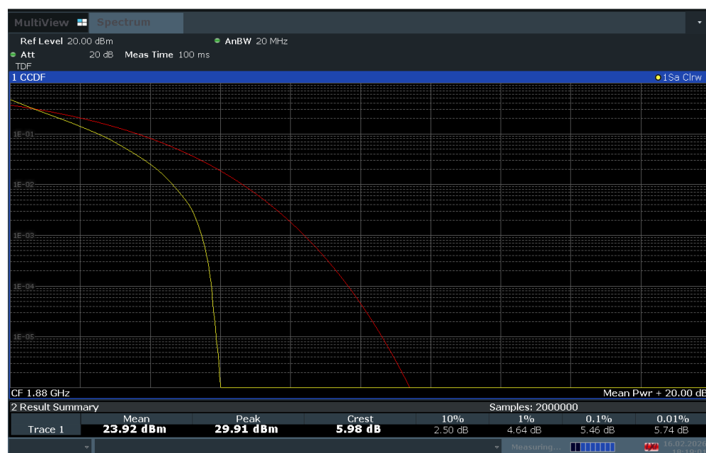
Plot 7-143. PAR Plot (LTE Band 2 - 15MHz QPSK - Full RB Configuration)
