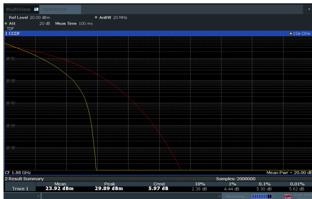
Plot 7-145. PAR Plot (LTE Band 2 - 20MHz QPSK - Full RB Configuration)
