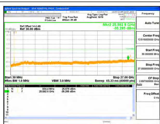
LTE B5 10MHz + 10MHz 16QAM Low Ch RB1-49 + RB1-0
