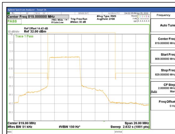
LTE B26 5MHz QPSK Low Channel RB25-0 (ID 12491)
