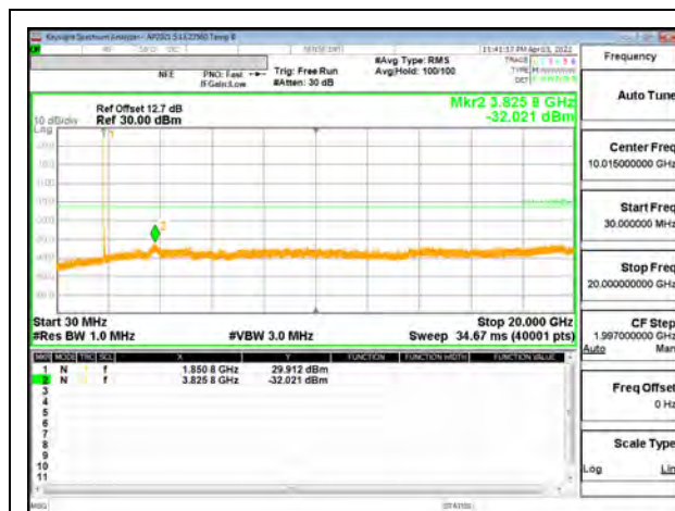
5G NR n25 40MHz BPSK Low Channel RB1-0
