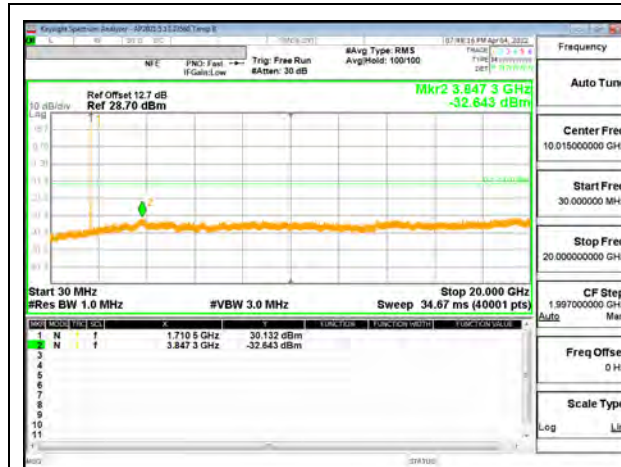
5G NR n66 5MHz BPSK Low Channel RB1-0
