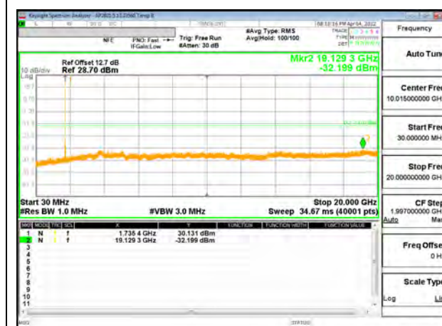
5G NR n66 20MHz BPSK Middle Channel RB1-1
