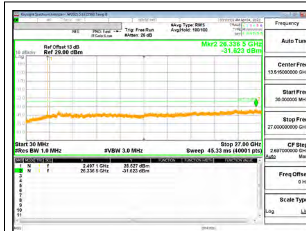
5G NR n41 20MHz BPSK Low Channel RB1-0
