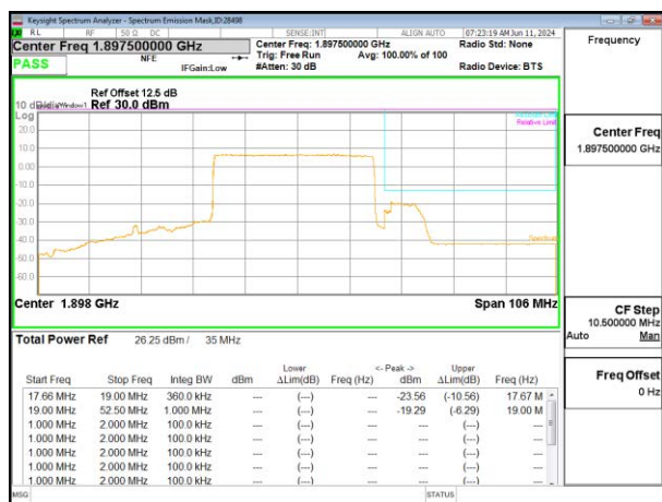
5G NR n25 35MHz BPSK High Channel RB180-0
