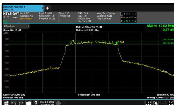
Figure 39 - 802.11ax HE20 SU Minimum 6 dB EBW
