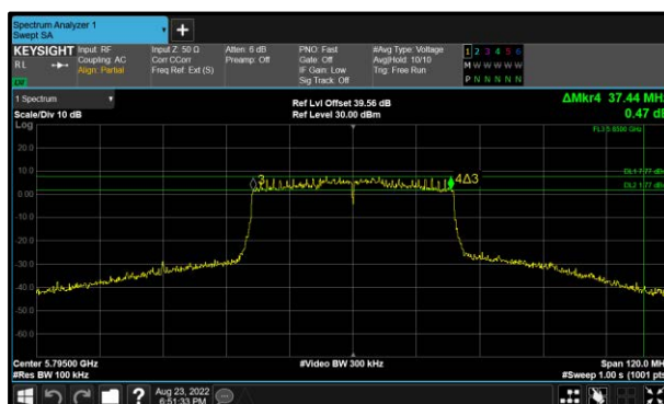
Figure 168 - 802.11ax HE40 SU Minimum 6 dB EBW
