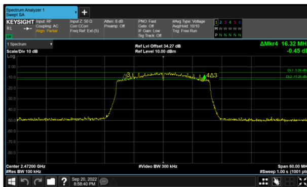
Figure 39 - 802.11ax HE20 SU Minimum 6 dB EBW
