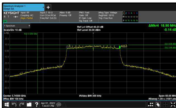
Figure 198 - 802.11ax HE20 SU Minimum 6 dB EBW
