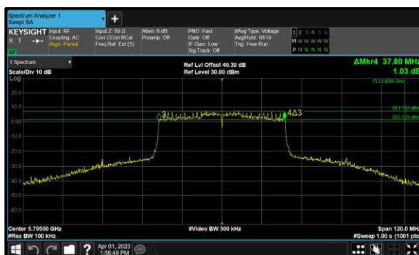
Figure 200 - 802.11ax HE40 SU Minimum 6 dB EBW
