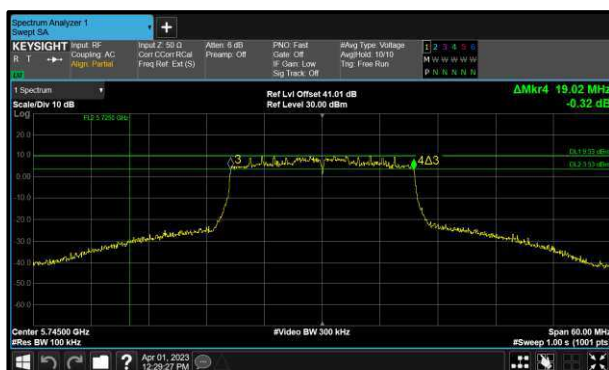
Figure 168 - 802.11ax HE20 SU Minimum 6 dB EBW
