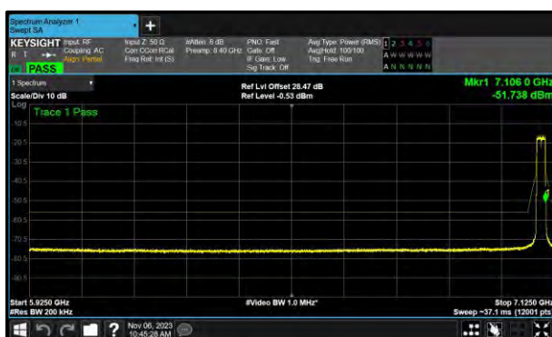
Figure 268 - A (Core 0) 802.11ax HE20 SU LPI 7095 MHz (CH229)
