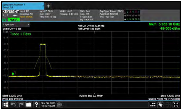
Figure 282 - A (Core 0) 802.11ax HE40 SU LPI 6165 MHz (CH43)
