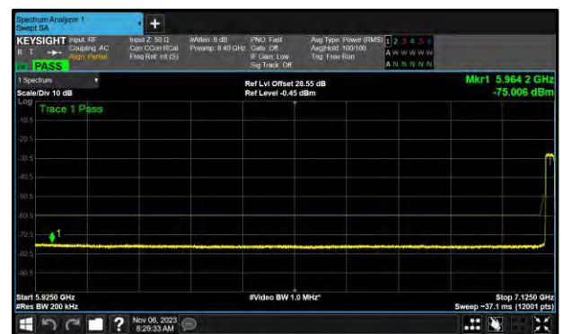
Figure 240 - A (Core 0) 802.11ax HE20 SU LPI 7115 MHz (CH233)
