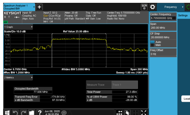
Plot 7-67 26dB BW & 99% OBW Antenna 2a (80MHz BW 802.11be(SU) - Ch.151)
