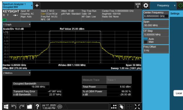
Plot 7-129 26dB BW & 99% OBW Antenna 2a (20MHz BW 802.11be(RU) RU242 Index61 - Ch.189)
