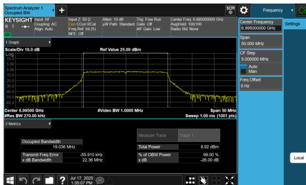
Plot 7-130 26dB BW & 99% OBW Antenna 2a (20MHz BW 802.11be(RU) RU242 Index61 - Ch.209)
