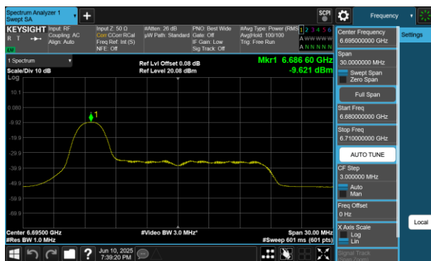
Plot 7-243 PSD Antenna 2a (20MHz BW 802.11be(RU) RU26 Index0 - Ch.149)
