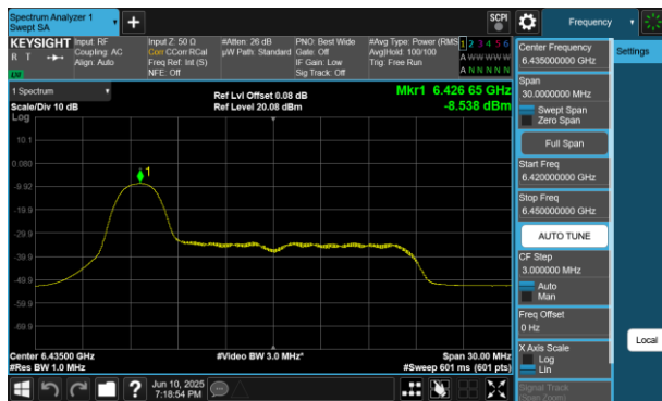
Plot 7-232 PSD Antenna 2a (20MHz BW 802.11be(RU) RU26 Index0 - Ch.97)
