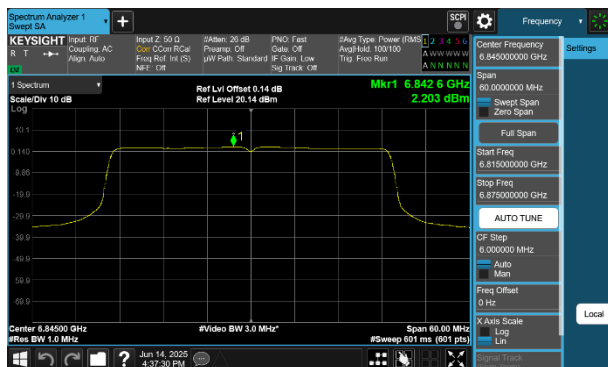
Plot 7-150 PSD Antenna 2a (40MHz BW 802.11be(SU) - Ch.179)
