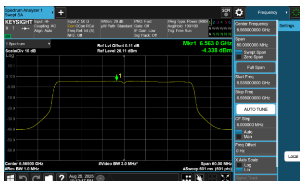
Plot 7-372 PSD Antenna 4a(40MHz BW 802.11be(RU) RU484 Index65 - Ch.123)
