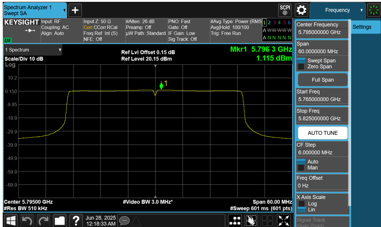
Plot 7-49 PSD Antenna 2a (40MHz BW 802.11be(SU) - Ch.159)
