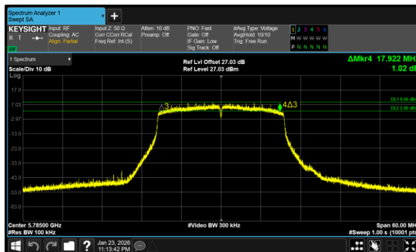
Figure 689 - 802.11ax HE20 SU Minimum 6 dB EBW
