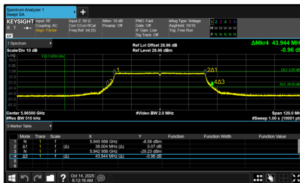
Figure 291 - 802.11ax HE40 SU LPI Minimum 26 dB EBW
