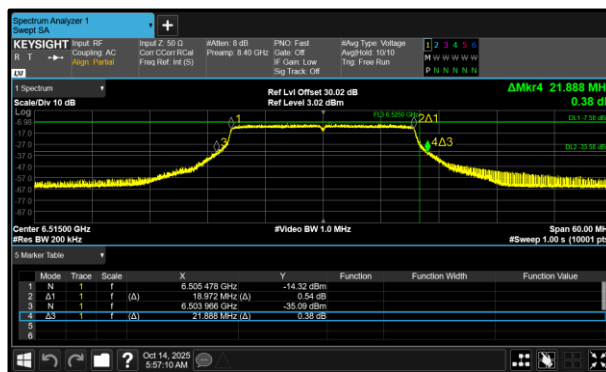
Figure 289 - 802.11ax HE20 SU LPI Minimum 26 dB EBW
