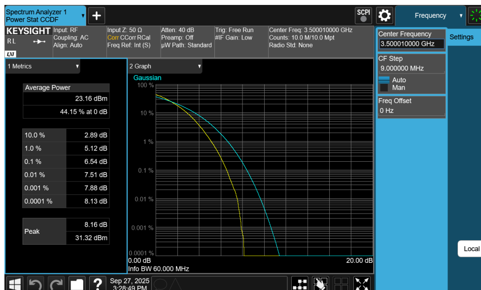
Plot 7-322. PAR Plot (NR Band n77 DoD-Band - 60MHz DFT-s-OFDM 256-QAM - Full RB)
