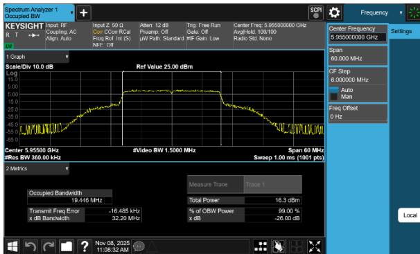
Plot 7-41 26dB BW & 99% OBW Antenna 3a (20MHz BW 802.11be(SU) - Ch.1)
