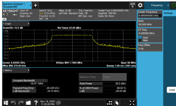
Plot 7-9 26dB BW & 99% OBW Antenna 3c (20MHz BW 802.11be(SU) - Ch.149)
