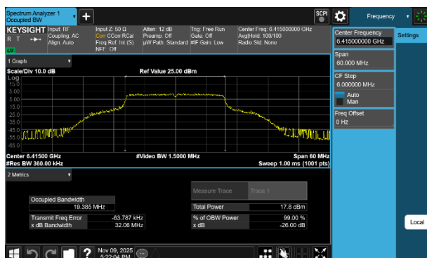
Plot 7-69 26dB BW & 99% OBW Antenna 1b (20MHz BW 802.11be(SU) - Ch.93)
