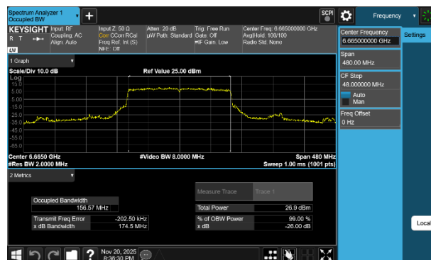
Plot 7-68 26dB BW & 99% OBW Antenna 1b (160MHz BW 802.11be(SU) - Ch.143)
