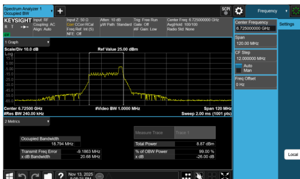
Plot 7-134 26dB BW & 99% OBW Antenna 3a (40MHz BW 802.11be(RU) RU26 Index8 - Ch.155)
