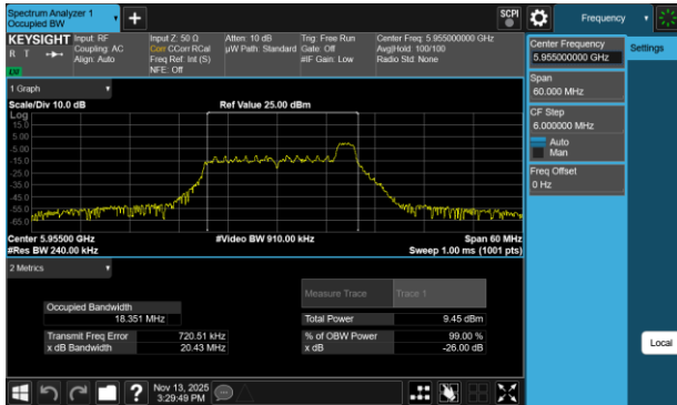
Plot 7-111 26dB BW & 99% OBW Antenna 3a (20MHz BW 802.11be(RU) RU26 Index8 - Ch.1)
