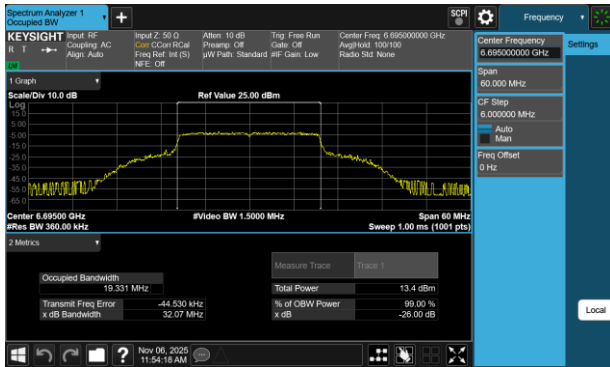
Plot 7-25 26dB BW & 99% OBW Antenna 3b (20MHz BW 802.11be(SU) - Ch.149)
