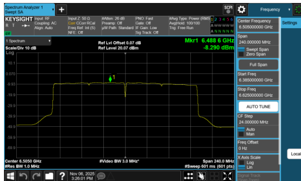
Plot 7-72 PSD Antenna 3b (160MHz BW 802.11be(SU) - Ch.111)
