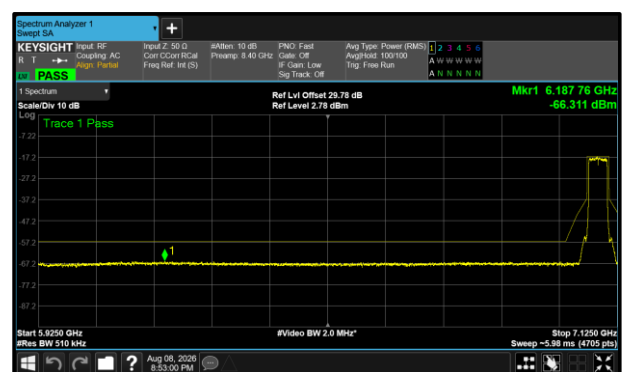
Figure 717 - B(Core 1) 802.11ax HE40 SU LPI 7085 MHz (CH227)
