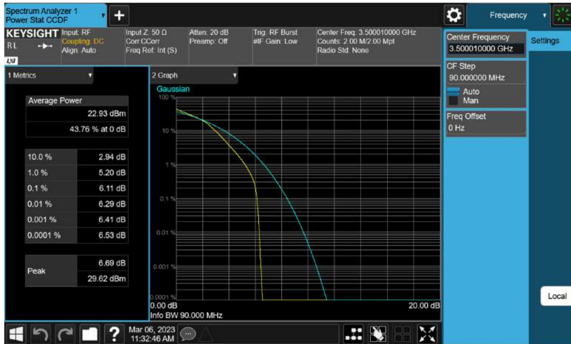
Sub6 n77(78). PAR Plot (90 M BW_Ch.633334_16QAM)
