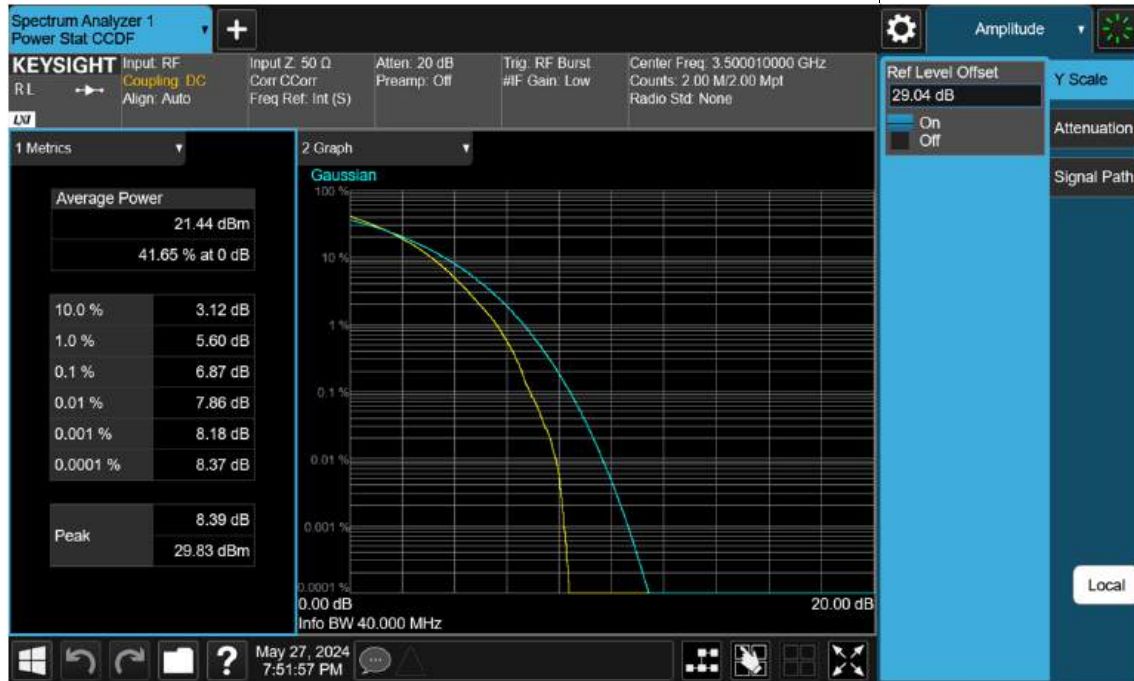
Sub6 n77(78). PAR Plot (40 M BW_Ch.633334_256 QAM)
