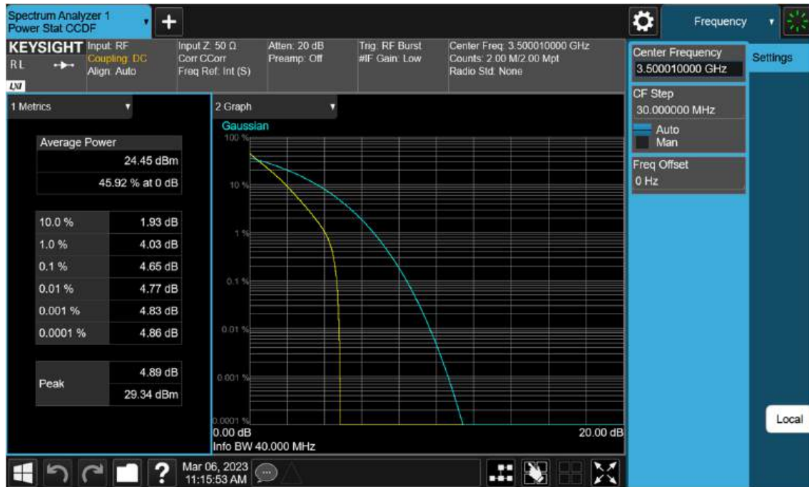
Sub6 n77(78). PAR Plot (40 M BW_Ch.633334_ BPSK)
