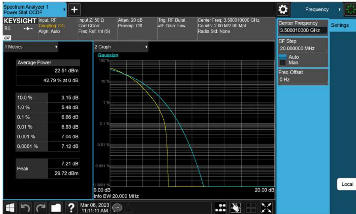
Sub6 n77(78). PAR Plot (20 M BW_Ch.633334_64 QAM)
