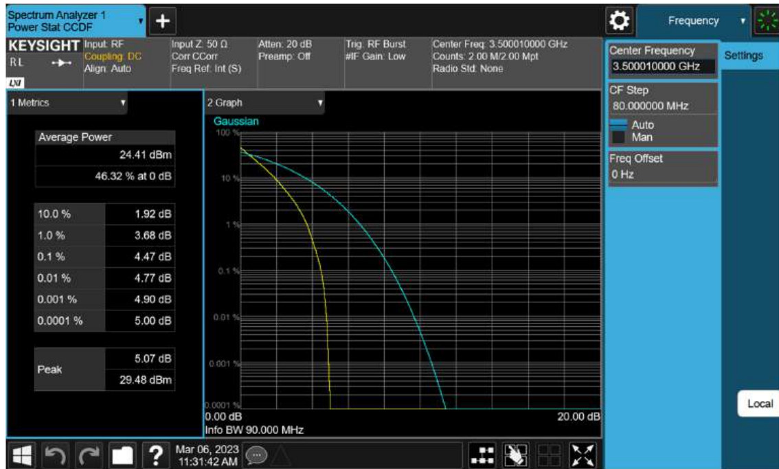
Sub6 n77(78). PAR Plot (90 M BW_Ch.633334_ BPSK)
