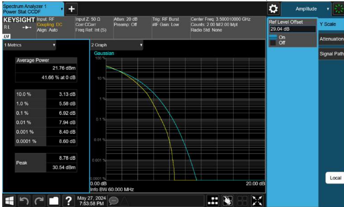
Sub6 n77(78). PAR Plot (60 M BW_Ch.633334_256 QAM)
