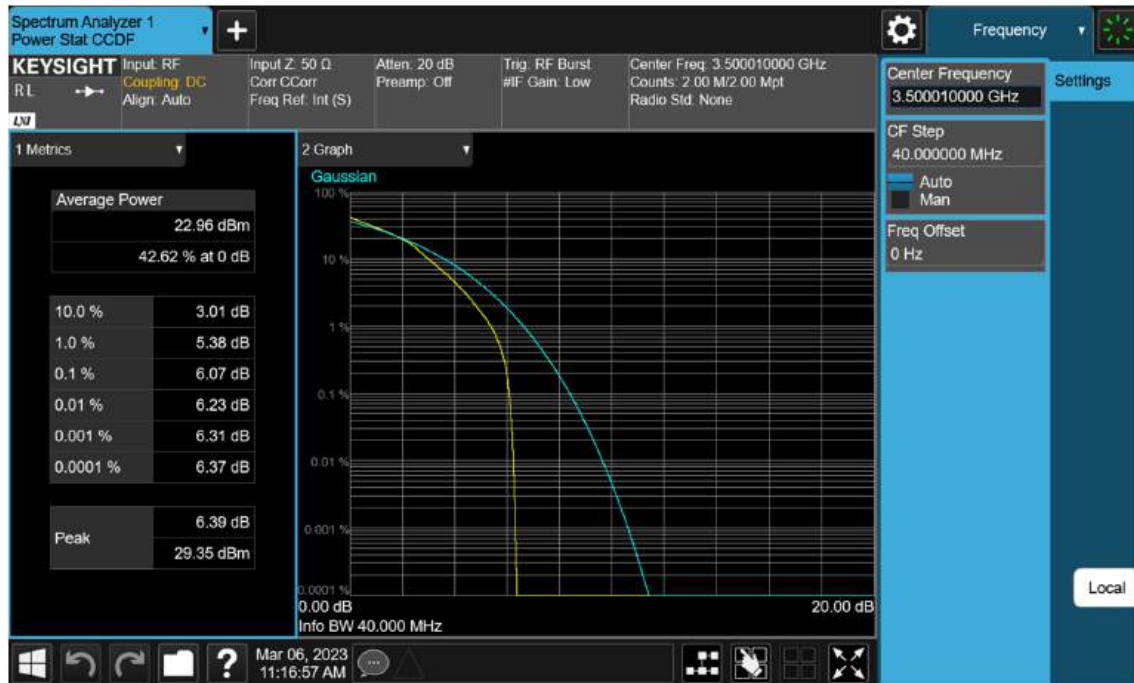
Sub6 n77(78). PAR Plot (40 M BW_Ch.633334_16QAM)
