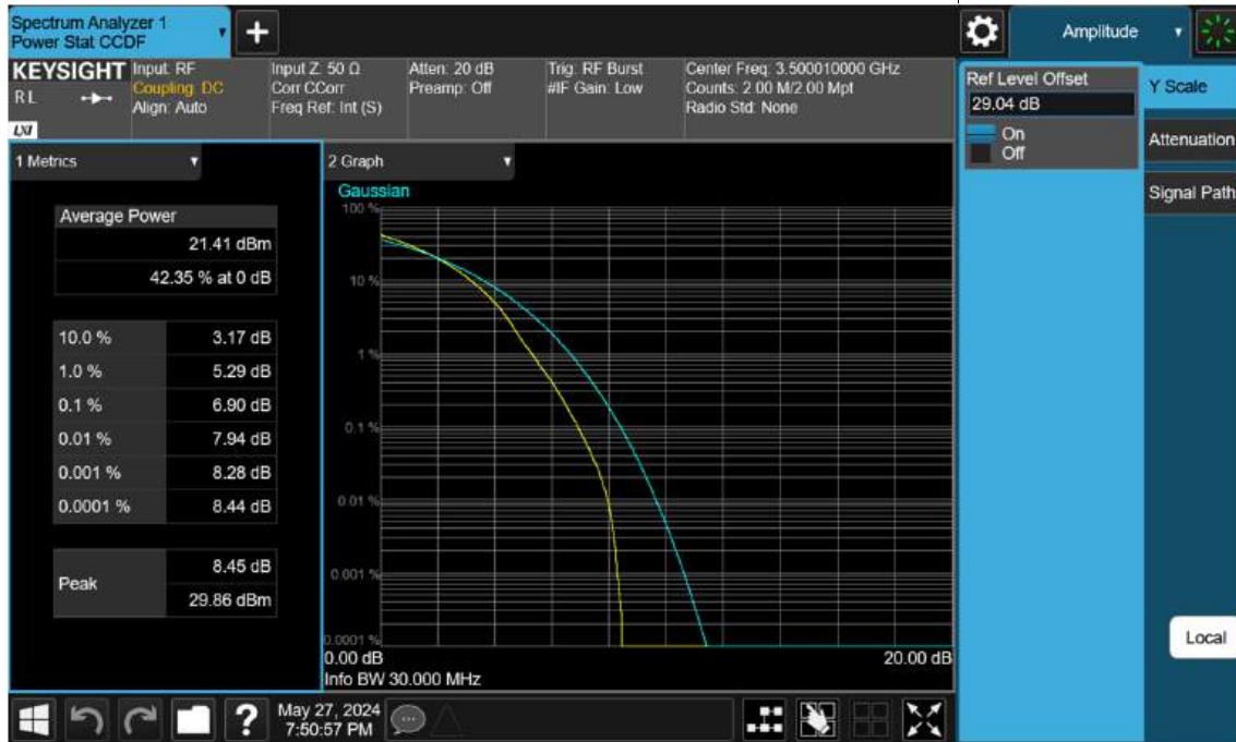
Sub6 n77(78). PAR Plot (30 M BW_Ch.633334_256 QAM)
