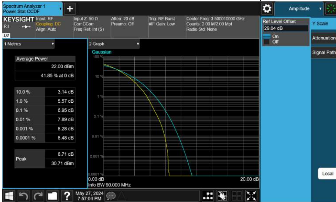
Sub6 n77(78). PAR Plot (90 M BW_Ch.633334_256 QAM)
