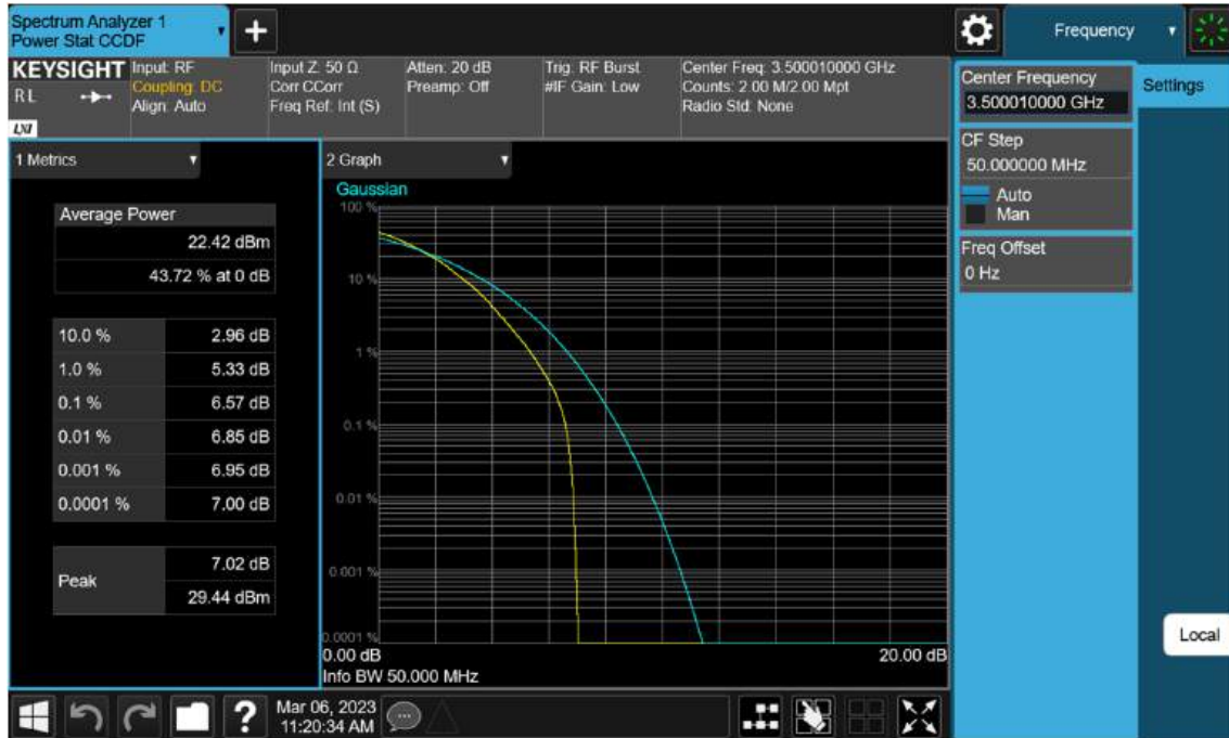
Sub6 n77(78). PAR Plot (50 M BW_Ch.633334_64 QAM)
