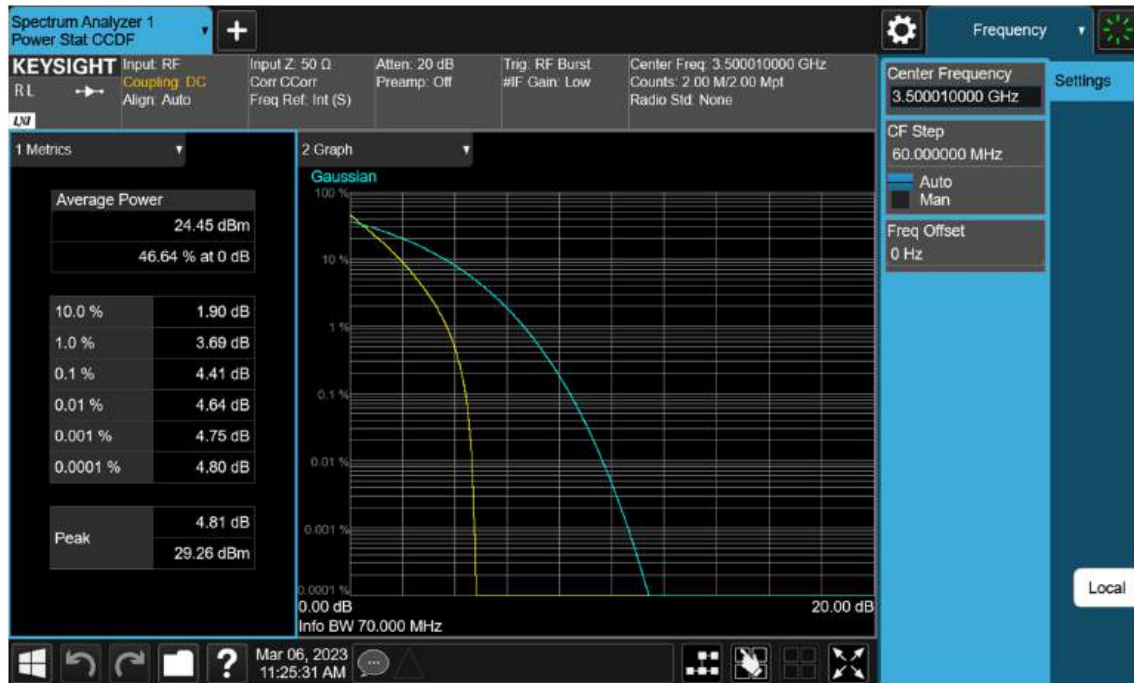
Sub6 n77(78). PAR Plot (70 M BW_Ch.633334_ BPSK)
