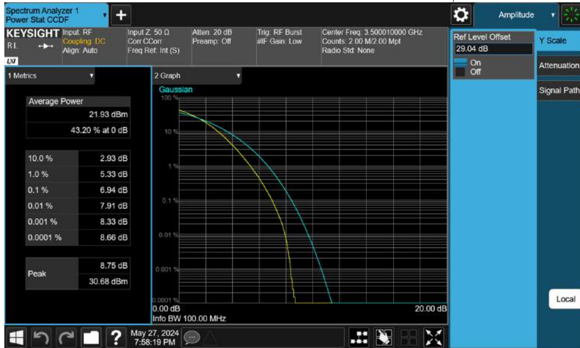
Sub6 n77(78). PAR Plot (100 M BW_Ch.633334_256 QAM)
