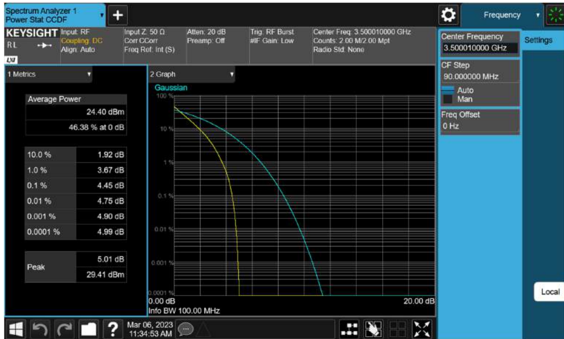
Sub6 n77(78). PAR Plot (100 M BW_Ch.633334_ BPSK)
