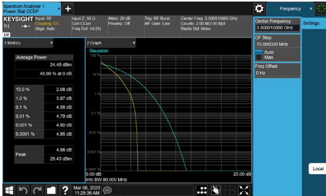
Sub6 n77(78). PAR Plot (80 M BW_Ch.633334_ BPSK)
