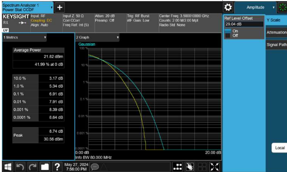
Sub6 n77(78). PAR Plot (80 M BW_Ch.633334_256 QAM)
