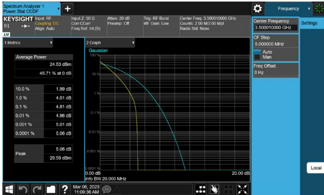
Sub6 n77(78). PAR Plot (20 M BW_Ch.633334_ BPSK)
