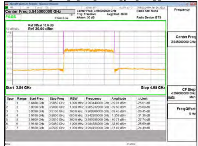
Band77-Part27 70MHz CP OFDM SCS30kHz QPSK RB189 0 CH663000
