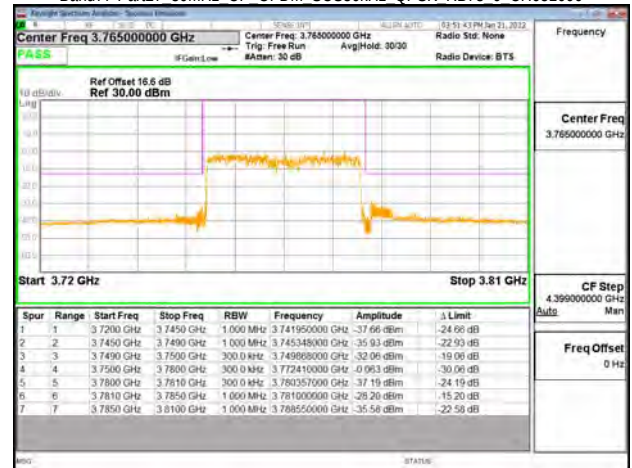
Band77-Part27 30MHz CP OFDM SCS30kHz QPSK RB78 0 CH656000
