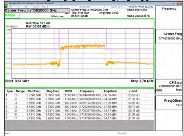
Band77-Part27 30MHz CP OFDM SCS30kHz QPSK RB78 0 CH651000
