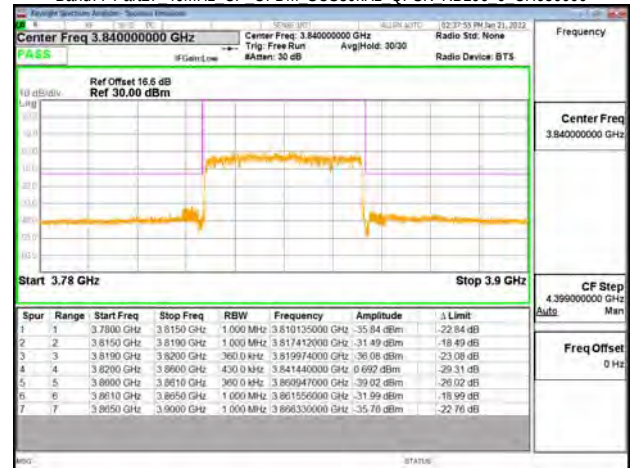
Band77-Part27 40MHz CP OFDM SCS30kHz QPSK RB106 0 CH664000
