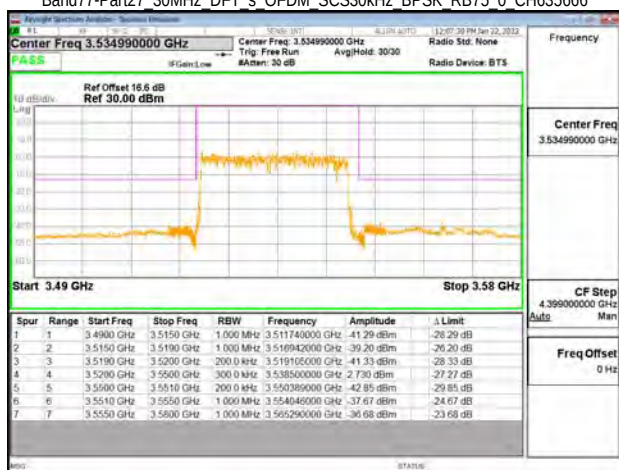
Band77-Part27 30MHz DFT s OFDM SCS30kHz BPSK RB75 0 CH635666
