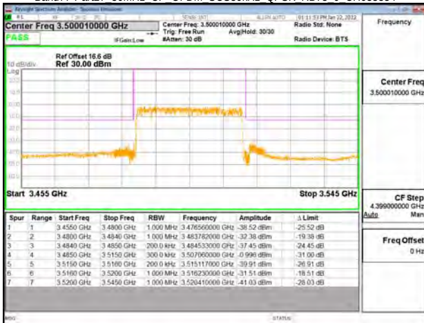
Band77-Part27 30MHz CP OFDM SCS30kHz QPSK RB78 0 CH635666
