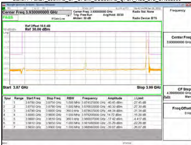
Band77-Part27 100MHz CP OFDM SCS30kHz QPSK RB1 272 CH662000
