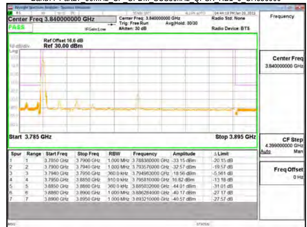
Band77-Part27 90MHz CP OFDM SCS30kHz QPSK RB1 0 CH656000
