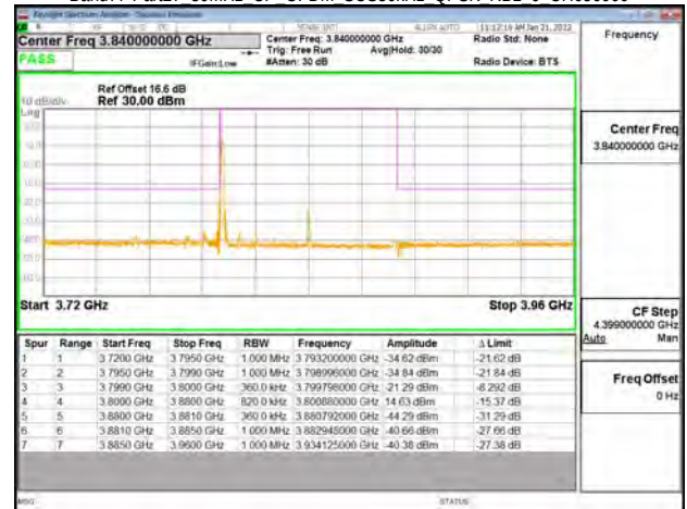
Band77-Part27 80MHz CP OFDM SCS30kHz QPSK RB1 0 CH662666
