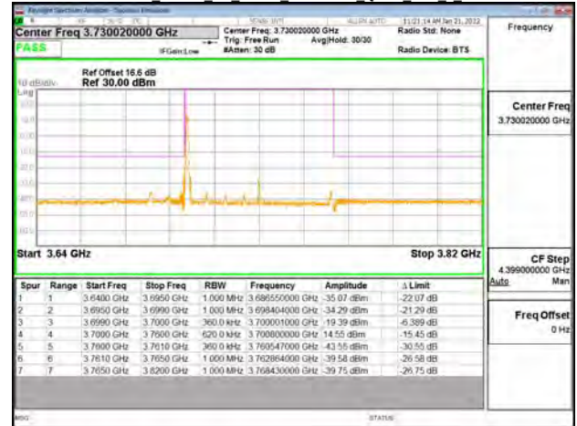
Band77-Part27 60MHz CP OFDM SCS30kHz QPSK RB1 0 CH656000
