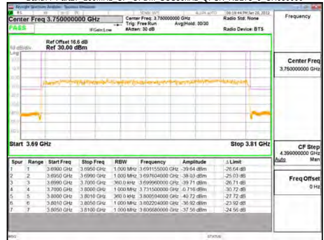
Band77-Part27 100MHz CP OFDM SCS30kHz QPSK RB273 0 CH650000
