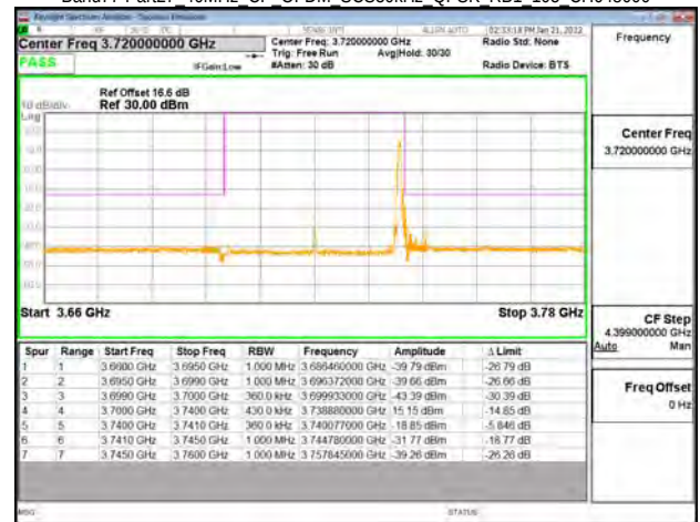
Band77-Part27 40MHz CP OFDM SCS30kHz QPSK RB1 105 CH656000
