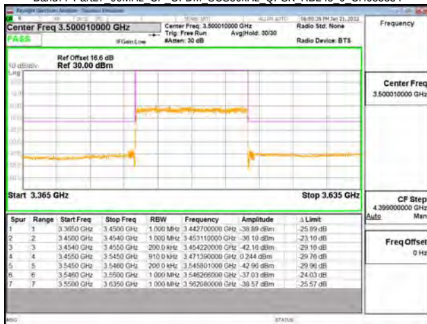
Band77-Part27 90MHz CP OFDM SCS30kHz QPSK RB245 0 CH633334
