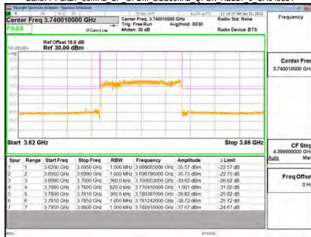
Band77-Part27 80MHz CP OFDM SCS30kHz QPSK RB217 0 CH656000
