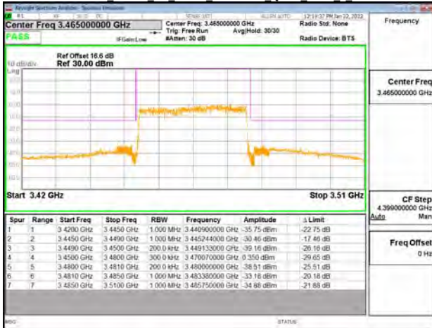
Band77-Part27 30MHz CP OFDM SCS30kHz QPSK RB78 0 CH633334
