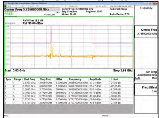
Band77-Part27 70MHz CP OFDM SCS30kHz QPSK RB1 0 CH656000
