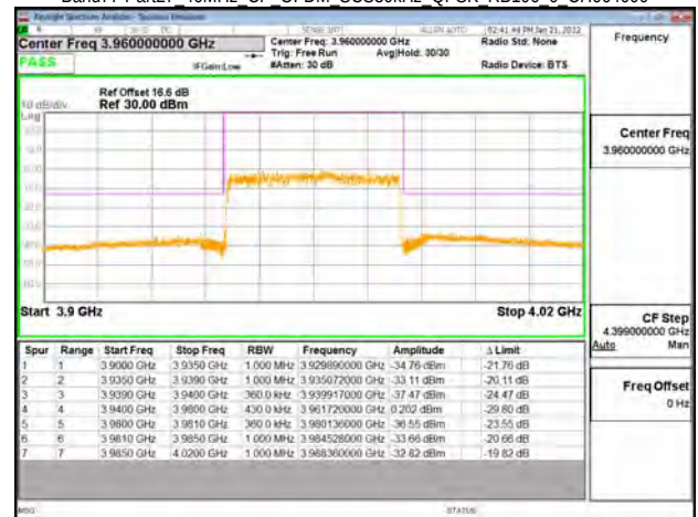
Band77-Part27 40MHz CP OFDM SCS30kHz QPSK RB106 0 CH664000
