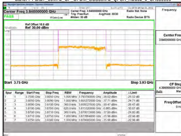
Band77-Part27 60MHz CP OFDM SCS30kHz QPSK RB162 0 CH663332
