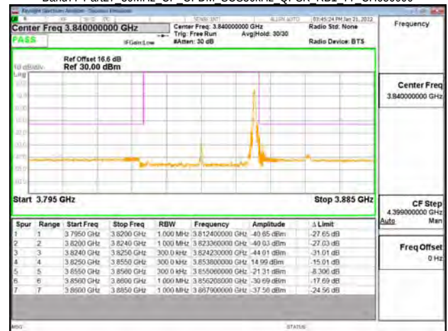
Band77-Part27 30MHz CP OFDM SCS30kHz QPSK RB1 77 CH656000
