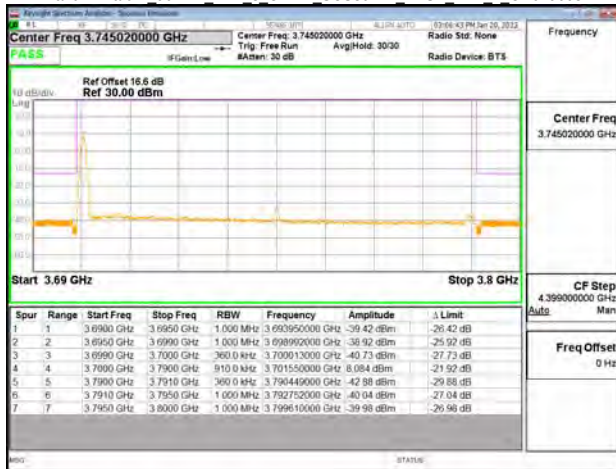
Band77-Part27 90MHz DFT s OFDM SCS30kHz BPSK RB1 244 CH633000
