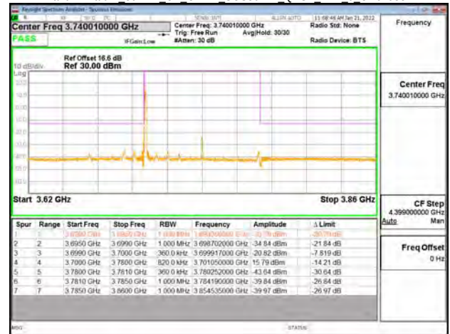
Band77-Part27 80MHz CP OFDM SCS30kHz QPSK RB1 0 CH656000
