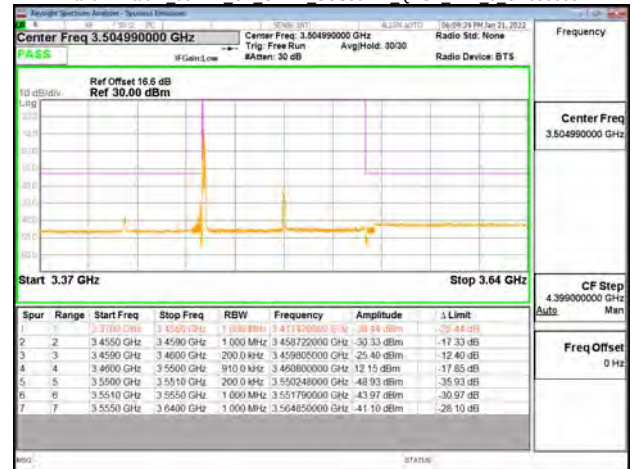
Band77-Part27 90MHz CP OFDM SCS30kHz QPSK RB1 0 CH649668
