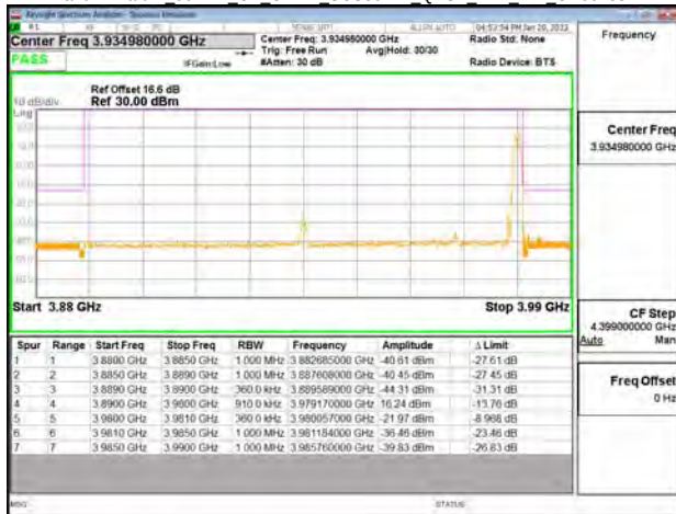
Band77-Part27 90MHz CP OFDM SCS30kHz QPSK RB245 0 CH633000
