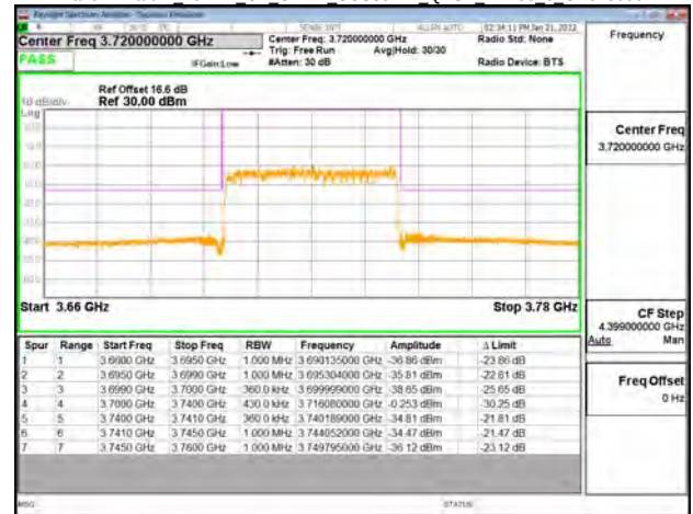
Band77-Part27 40MHz CP OFDM SCS30kHz QPSK RB106 0 CH656000
