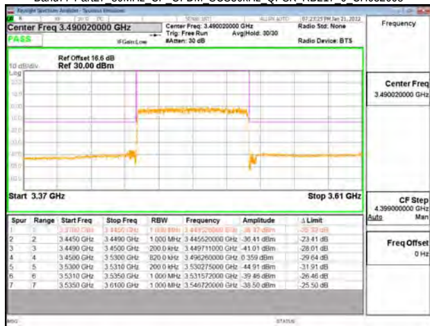
Band77-Part27 80MHz CP OFDM SCS30kHz QPSK RB217 0 CH633334
