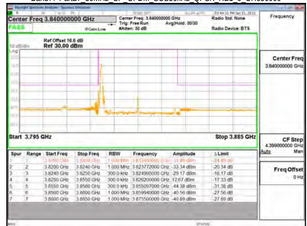
Band77-Part27 30MHz CP OFDM SCS30kHz QPSK RB1 0 CH656000
