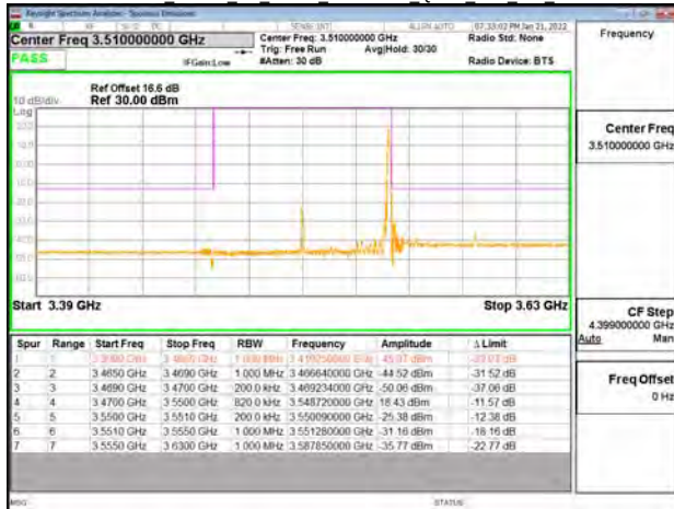
Band77-Part27 80MHz CP OFDM SCS30kHz QPSK RB1 216 CH634000
