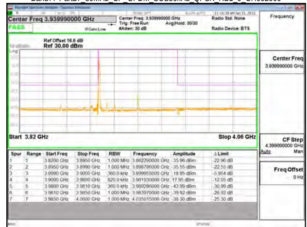
Band77-Part27 80MHz CP OFDM SCS30kHz QPSK RB1 0 CH662666
