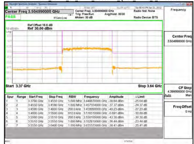
Band77-Part27 90MHz CP OFDM SCS30kHz QPSK RB245 0 CH649668
