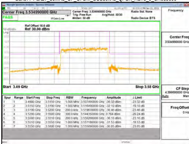
Band77-Part27 30MHz CP OFDM SCS30kHz QPSK RB78 0 CH635666
