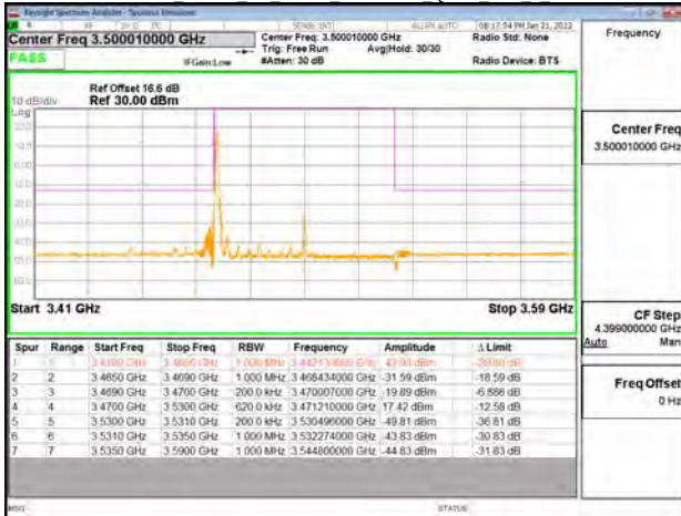
Band77-Part27 60MHz CP OFDM SCS30kHz QPSK RB1 0 CH634666
