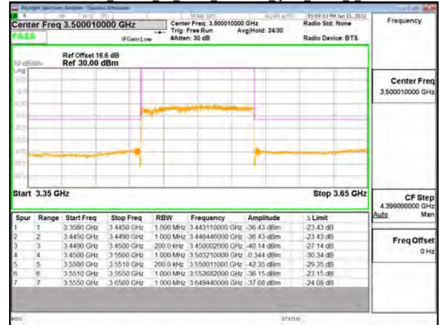
Band77-Part27 100MHz CP OFDM SCS30kHz QPSK RB273 0 CH650000
