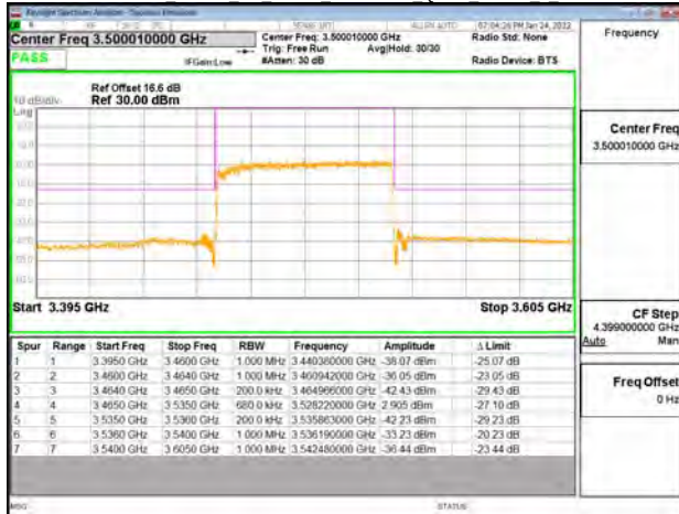
Band77-Part27 70MHz CP OFDM SCS30kHz QPSK RB189 0 CH634332
