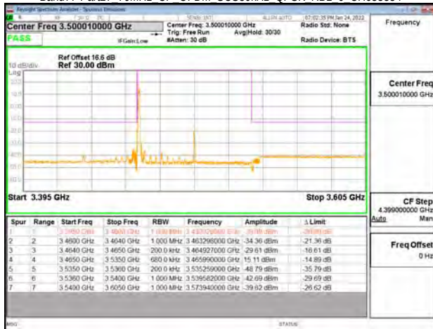
Band77-Part27 70MHz CP OFDM SCS30kHz QPSK RB1 0 CH634332
