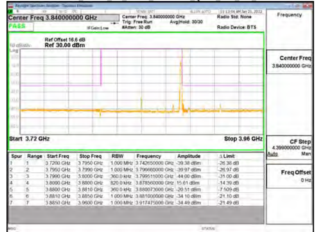
Band77-Part27 80MHz CP OFDM SCS30kHz QPSK RB1 216 CH662666
