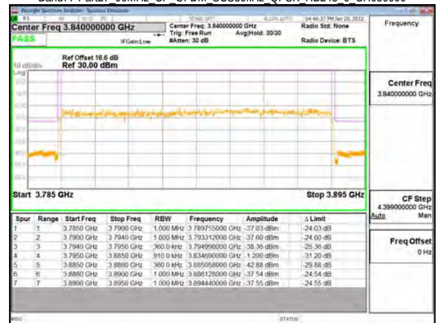
Band77-Part27 90MHz CP OFDM SCS30kHz QPSK RB245 0 CH656000
