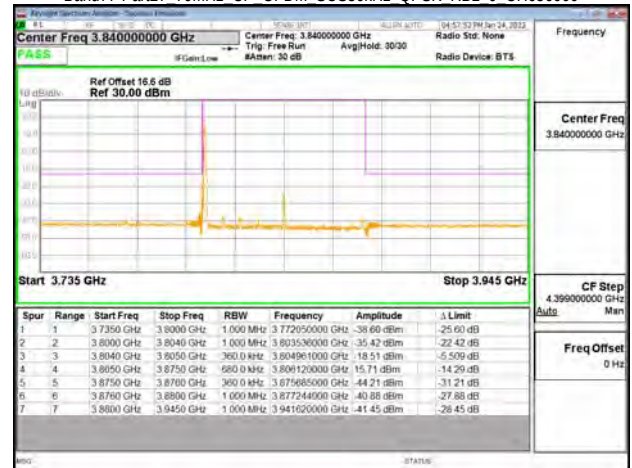
Band77-Part27 70MHz CP OFDM SCS30kHz QPSK RB1 0 CH663000
