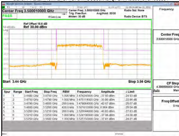
Band77-Part27 40MHz CP OFDM SCS30kHz QPSK RB106 0 CH635332
