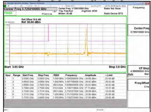
Band77-Part27 50MHz CP OFDM SCS30kHz QPSK RB1 132 CH656000
