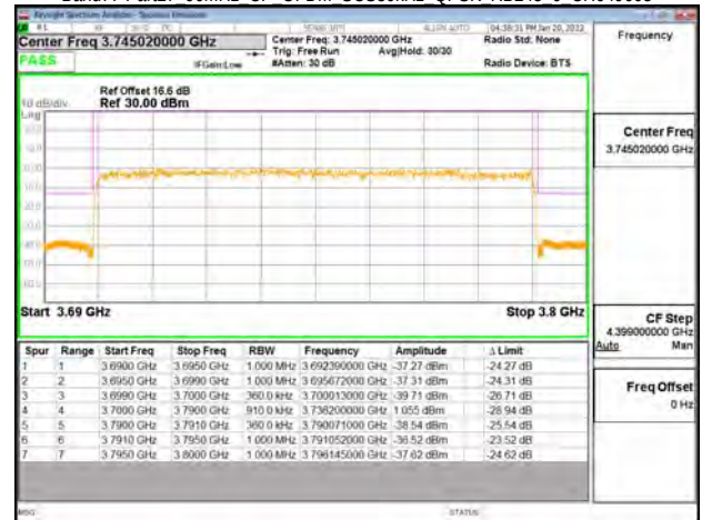
Band77-Part27 90MHz CP OFDM SCS30kHz QPSK RB245 0 CH656000
