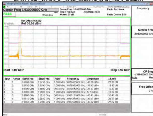
Band77-Part27 100MHz CP OFDM SCS30kHz QPSK RB1 272 CH633334
