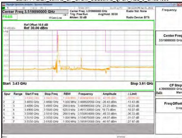
Band77-Part27 60MHz CP OFDM SCS30kHz QPSK RB1 0 CH634666
