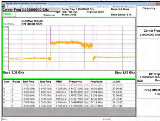
Band77-Part27 90MHz CP OFDM SCS30kHz QPSK RB245 0 CH633334
