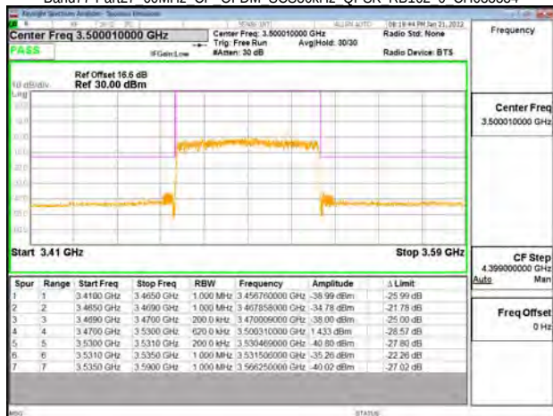
Band77-Part27 60MHz CP OFDM SCS30kHz QPSK RB162 0 CH634666
