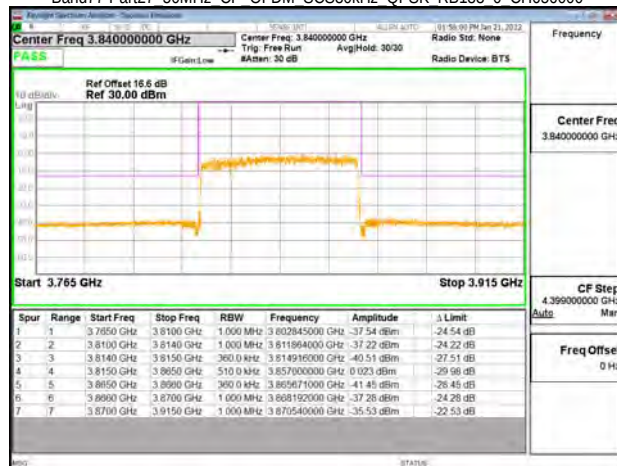
Band77-Part27 50MHz CP OFDM SCS30kHz QPSK RB133 0 CH663666
