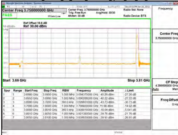
Band77-Part27 100MHz CP OFDM SCS30kHz QPSK RB1 272 CH656000
