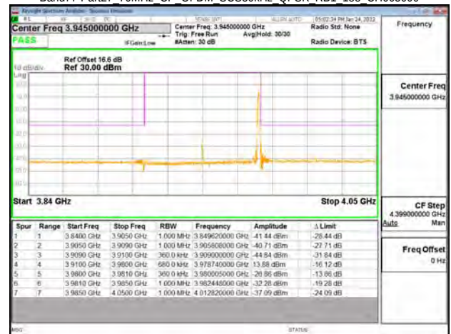
Band77-Part27 70MHz CP OFDM SCS30kHz QPSK RB1 188 CH663000
