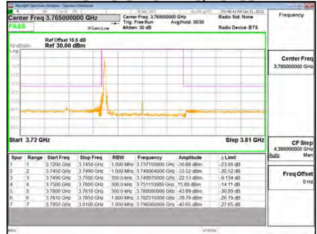
Band77-Part27 30MHz CP OFDM SCS30kHz QPSK RB1 0 CH656000
