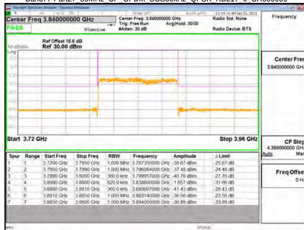
Band77-Part27 80MHz CP OFDM SCS30kHz QPSK RB217 0 CH662666
