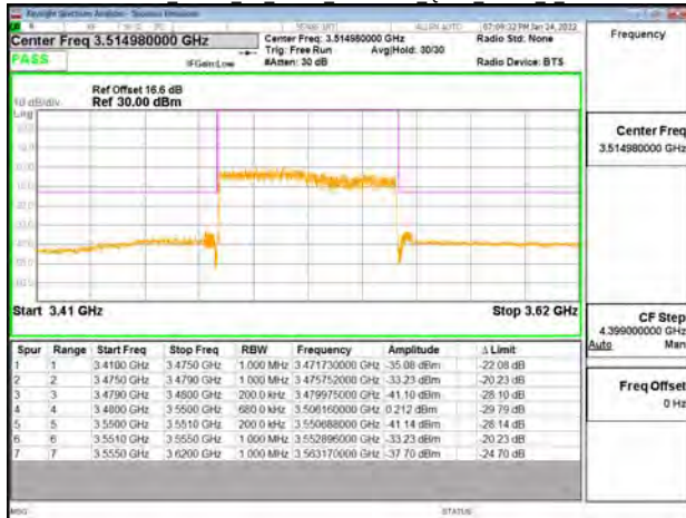
Band77-Part27 70MHz CP OFDM SCS30kHz QPSK RB189 0 CH634332
