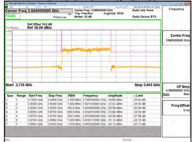
Band77-Part27 70MHz CP OFDM SCS30kHz QPSK RB189 0 CH663000
