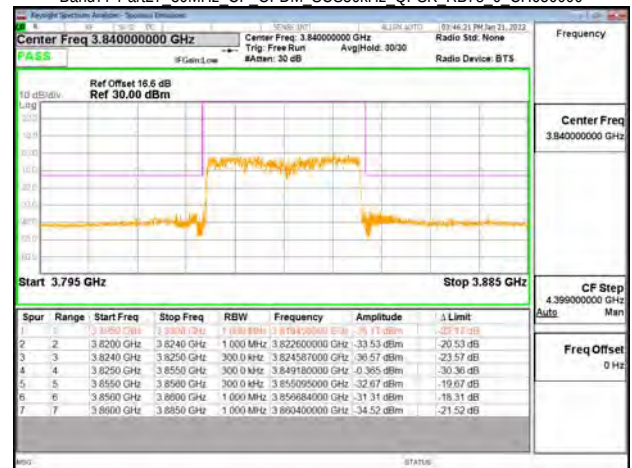
Band77-Part27 30MHz CP OFDM SCS30kHz QPSK RB78 0 CH656000
