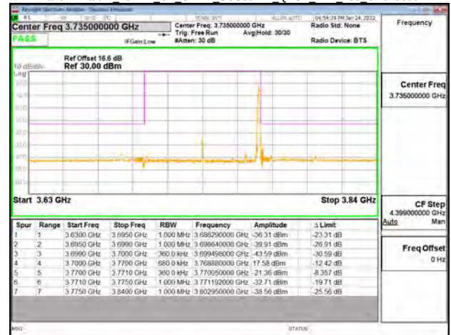
Band77-Part27 70MHz CP OFDM SCS30kHz QPSK RB1 188 CH656000
