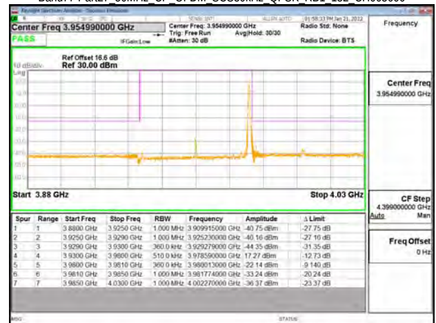
Band77-Part27 50MHz CP OFDM SCS30kHz QPSK RB1 132 CH663666
